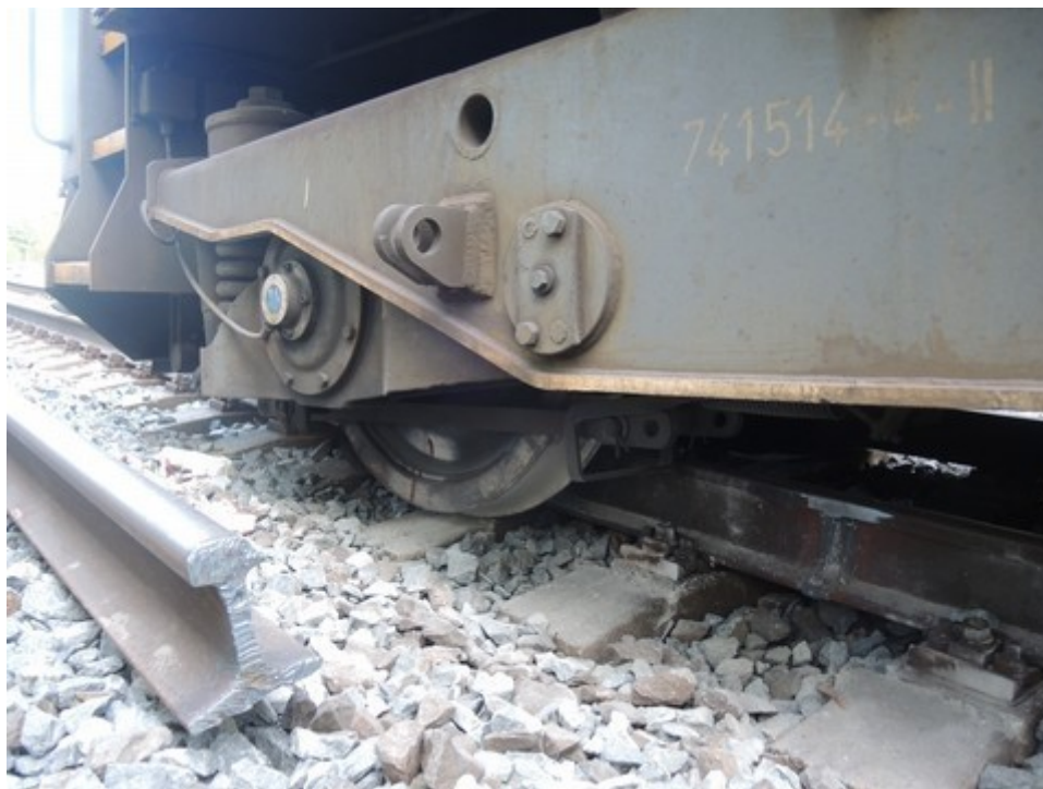
Obr. č. 1: Pohled na detail vykolejeného HDV
