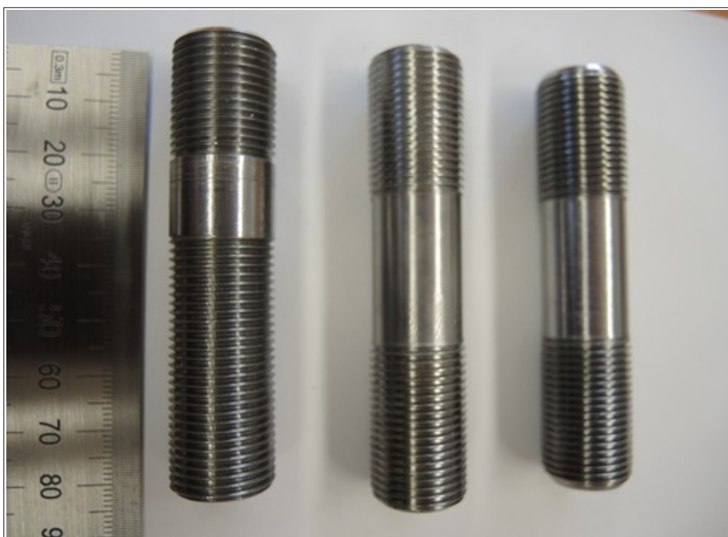
Obr. č. 11: Vlevo reklamovaný závrtný šroub, vpravo dva závrtné šrouby ze zakázek realizovaných DPMB po vzniku MU Zdroj: DI
