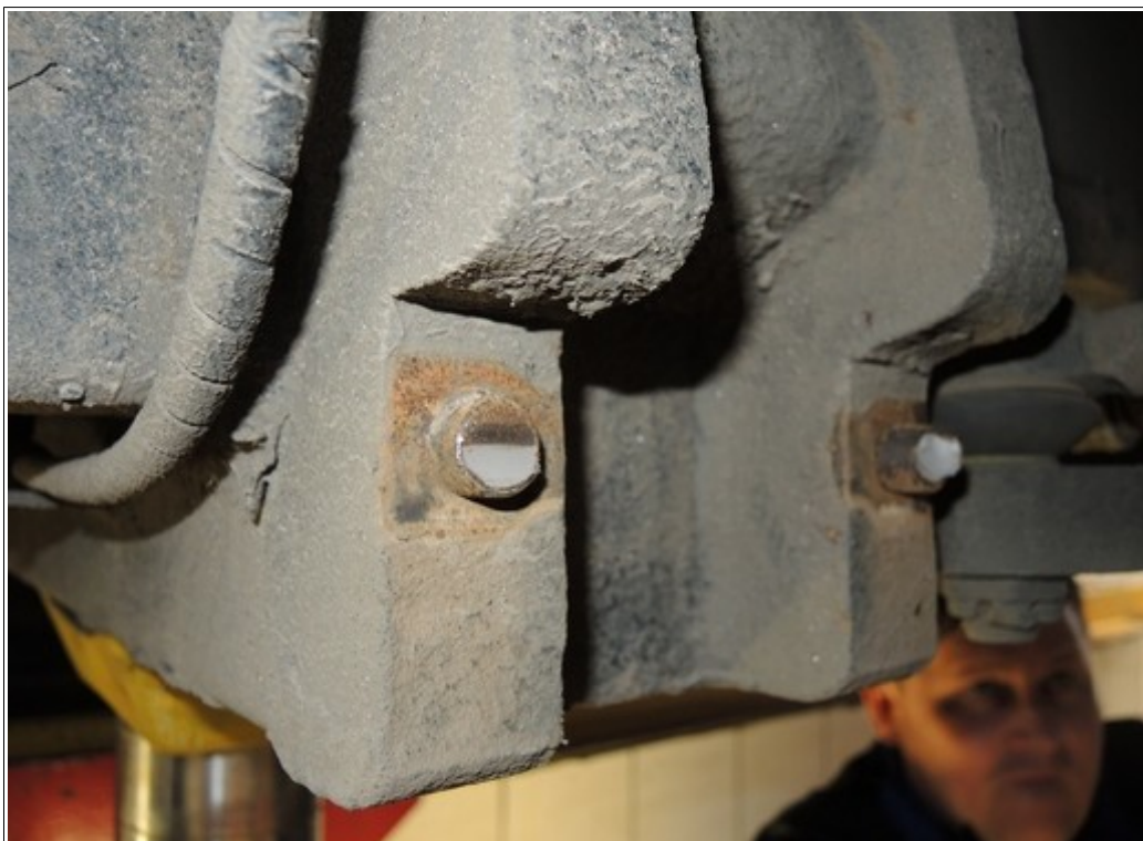
Obr. č. 10: Místo uchycení pravého spodního ramene trolejbusu, viditelné známky koroze na zadním závrtném šroubu Zdroj: DI
