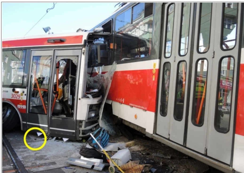
Obr. č. 5: Celkový pohled na místo, kde ležela odlomená část závrtného šroubu (přední šroub ve směru jízdy) Zdroj: DI
