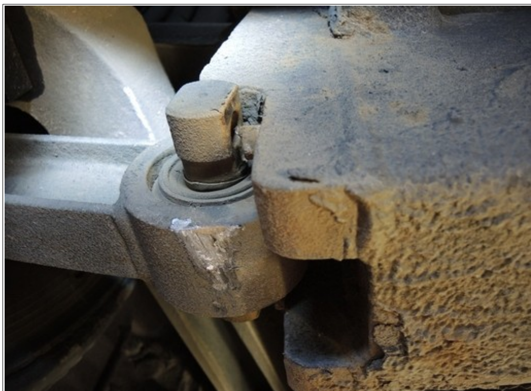
Obr. č. 9: Poškození spodní části spodního ramene pravého předního kola po jeho svěšení za jízdy a zbytek předního závrtného šroubu v rámu DV
