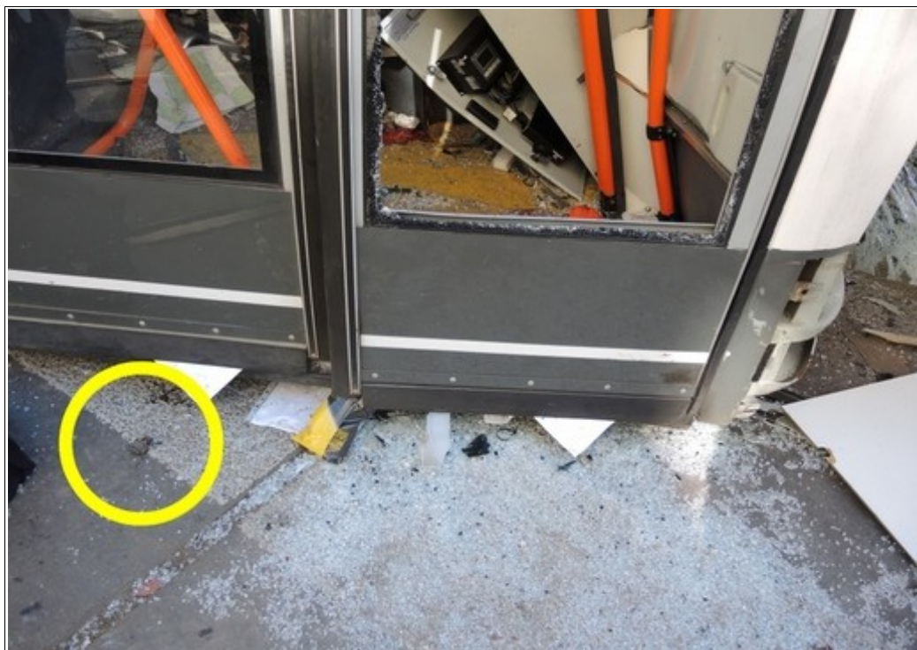
Obr. č. 4: Odlomená část závrtného šroubu (přední šroub ve směru jízdy) uchycení pravého spodního ramene po vzniku MU Zdroj: DI
