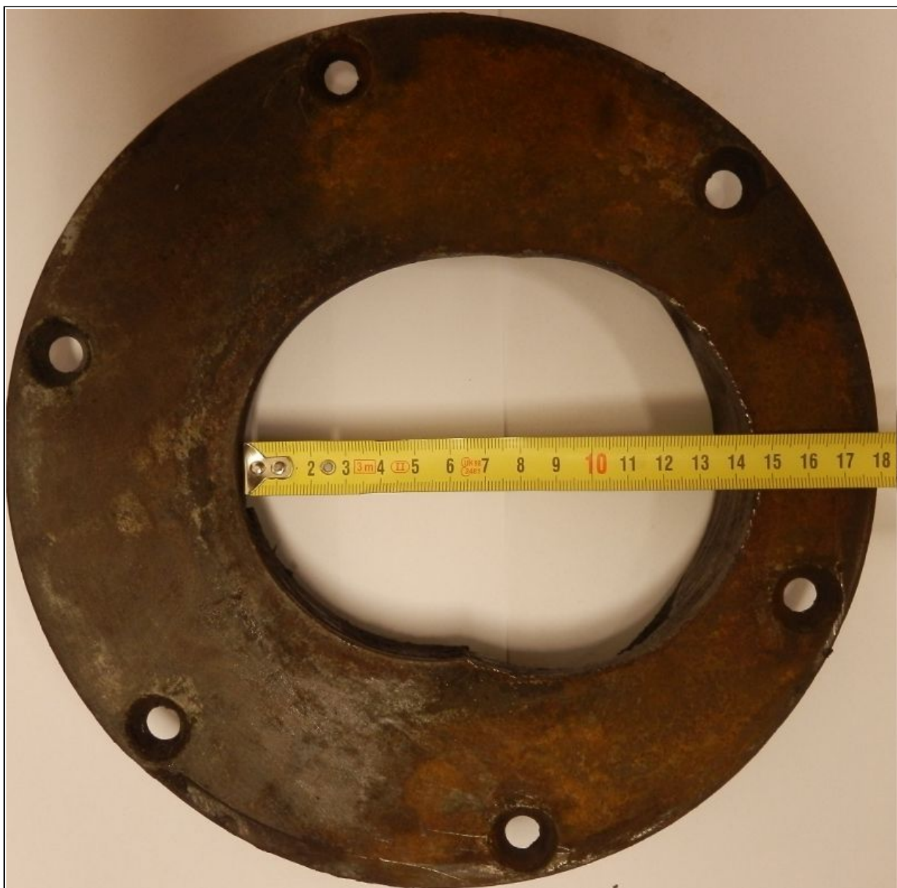
Obr. č. 8: Poškozené levé víko ložiskové skříně 1. nápravy zadního podvozku DV MTV, ev. č. 1313.
