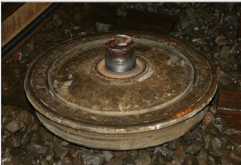
Obr. č. 5: Levé kolo s částí odlomené 1. nápravy zadního podvozku DV MTV, ev. č. 1313.
