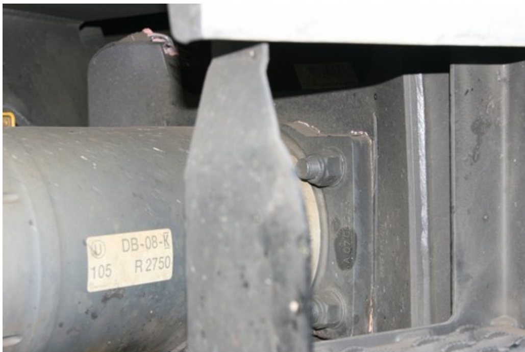
Obr. č. 4: Poškození deformační zóny HDV 91 80 6186 237-4 D-LTE
