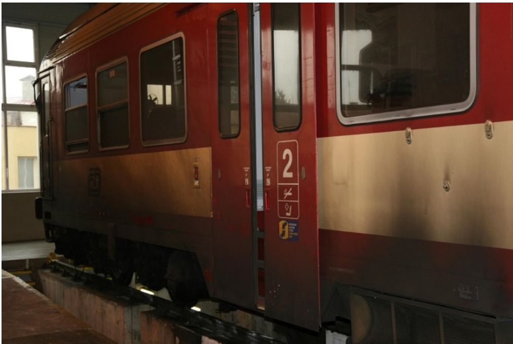
Obr. č. 1: Pohled na ohořelé HDV 843.021-7
