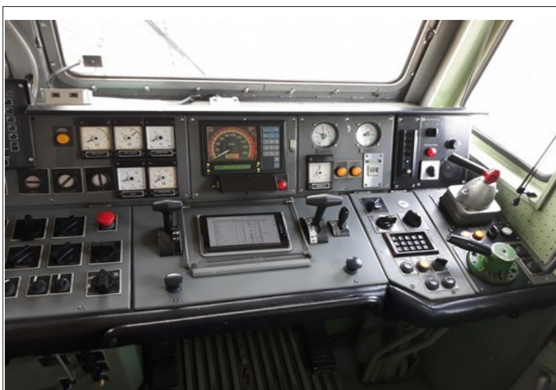
Obr. č. 4: Řídicí pult stanoviště strojvedoucího HDV řady 362
