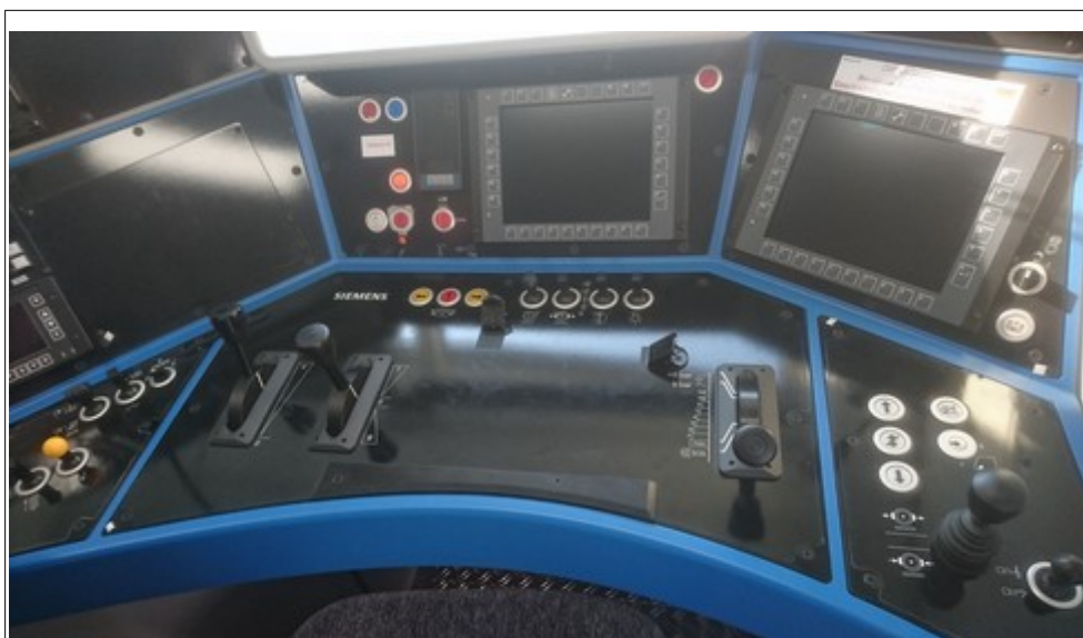
Obr. č. 7: Řídicí pult stanoviště strojvedoucího HDV řady 193 (Vectron)
