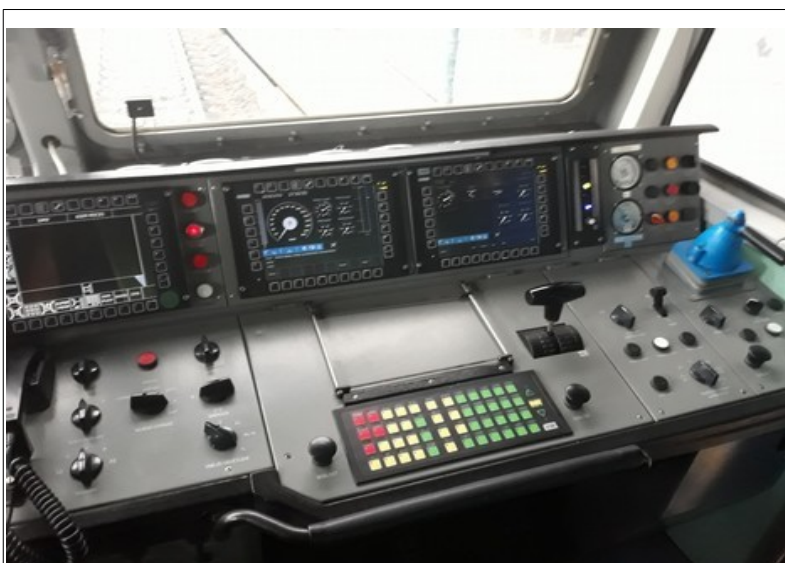
Obr. č. 5: Řídicí pult stanoviště strojvedoucího HDV řady 362 – úprava WTB
