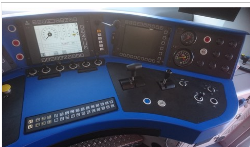
Obr. č. 6: Řídicí pult stanoviště strojvedoucího HDV řady 380
