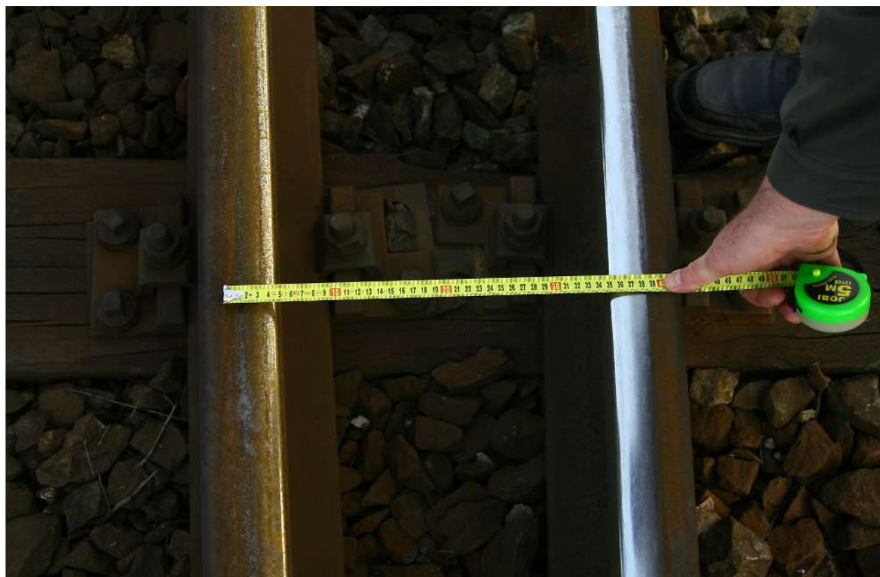
Foto 6: První stopa – tření silentbloku pravé šikmé tyče po odbočné kolejnici výhybky č. 5
