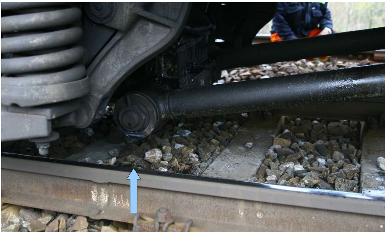
Foto 13: Stopa na silentbloku šikmé tyče po tření o odbočnou kolejnici výhybky č. 3
