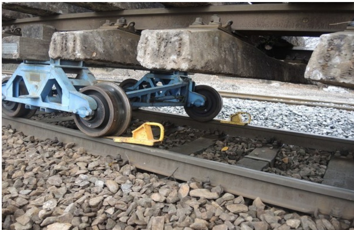
Obr. č. 11: Podvozek Vz 53/77 zajištěný zarážkami při ověřovacím pokusu
