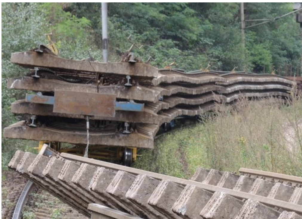
Obr. č. 2: přetržení vlaku mezi 3. a 4. svazkem kolejových polí, směrem k začátku vlaku, a pohled na způsob naložení kolejových párů
