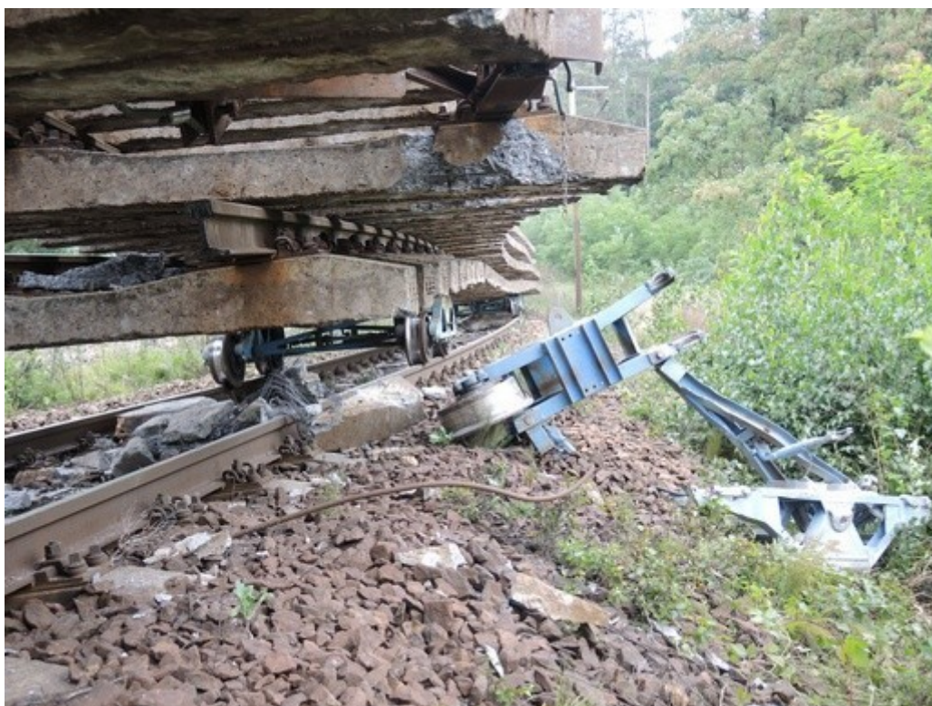
Obr. č. 6: zdemolovaný podvozek č. 6029 a betonový pražec
