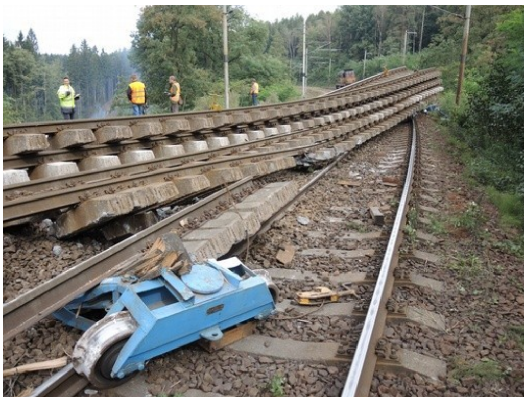
Obr. č. 3: Vykolejený podvozek č. 8535
