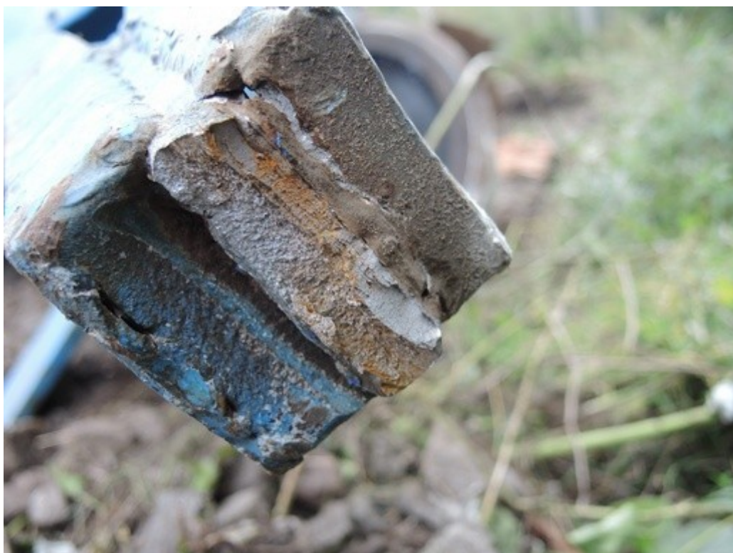
Obr. č. 5: Starý lom v místě navaření oka podvozku č. 8535
