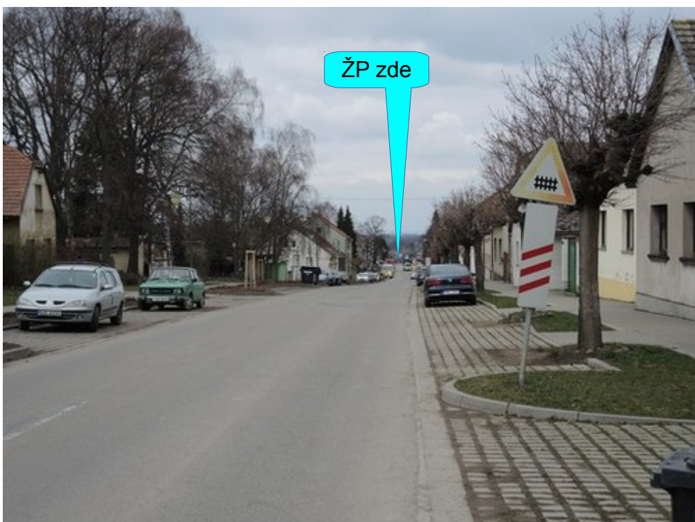
Obr. č. 7: Viditelnost na ŽP z pohledu řidiče (240 m před ŽP)
