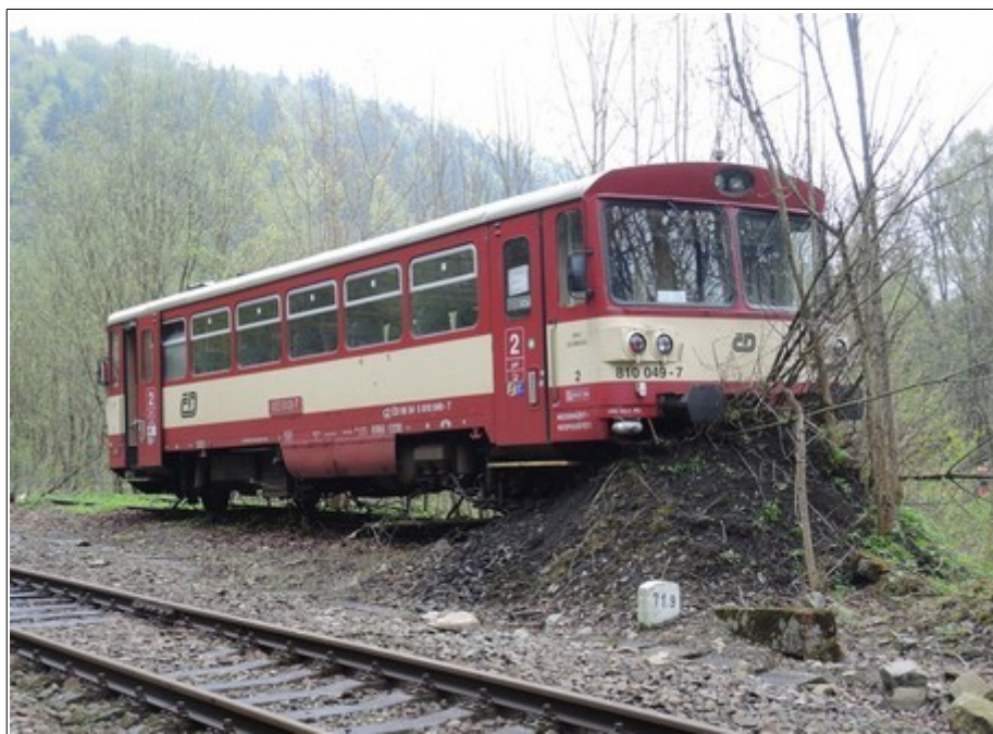
Obr. č. 1: Pohled na místo MU ze směru od stavědla St. 1 žst. Hanušovice, dokumentující HDV 95 54 5 810 049-7 vlaku Os 13659 v konečném postavení po MU, tzn. po srážce se zemním zarážedlem KSK č. 105 a ve vykolejeném stavu.
