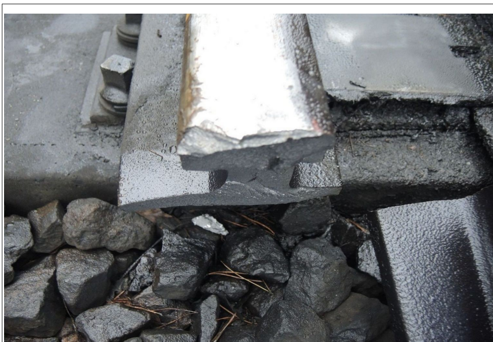
Obr. č. 3: Pohled na lom jazyka výhybky č. 11 po vzniku MU
