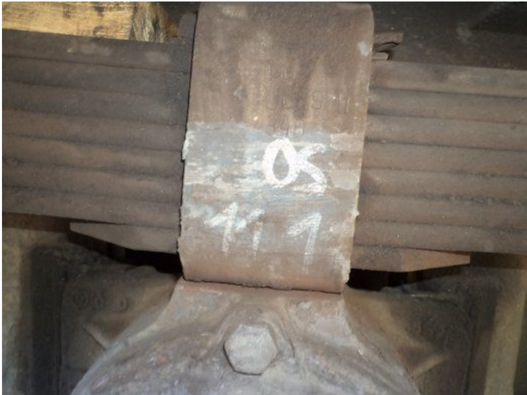
Obr. č. 9: Vyznačení defektoskopické kontroly na pružnici
