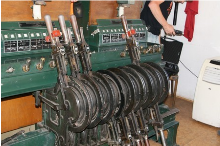
Obr. č. 18: Polohy výměnových pák a kolejových závěrníků na St. 2 Zdroj: DI
