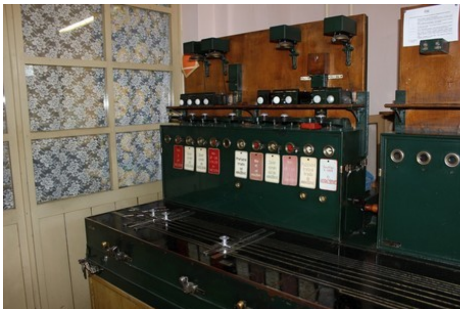
Obr. č. 19: Poloha clonek hradlových závěrů, směrových závěrníků a posuvných knoflíků na řídicím přístroji (část řídicího přístroje pro pačejevské zhlaví) Zdroj: DI
