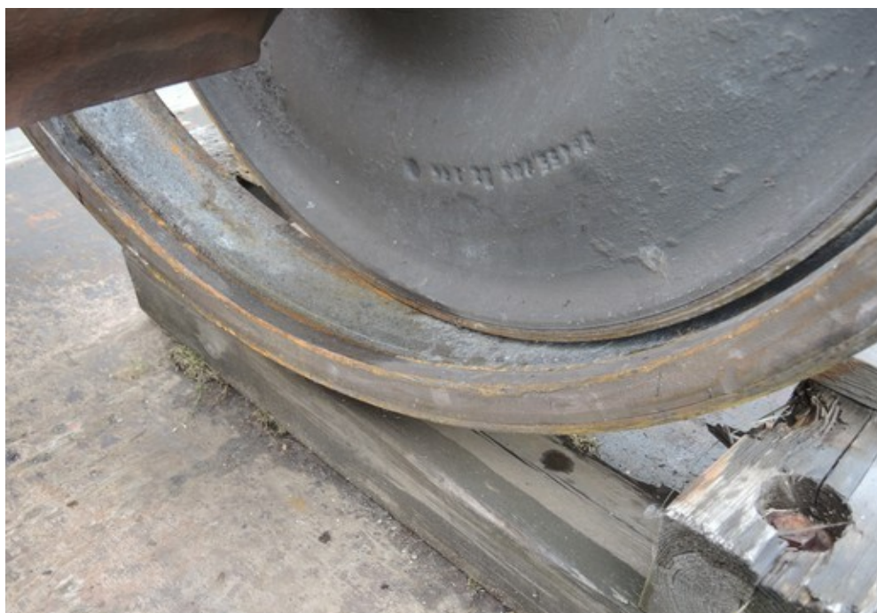
Obr. č. 4: Detail vysvléknuté obruče po demontáži dvojkolí
