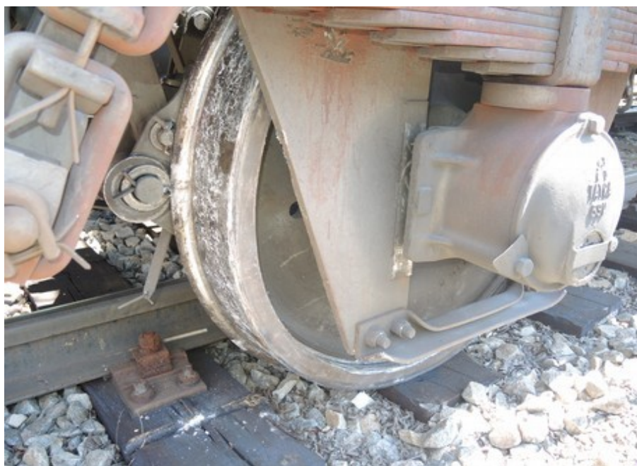
Obr. č. 1: Detail vykolejeného dvojkolí
