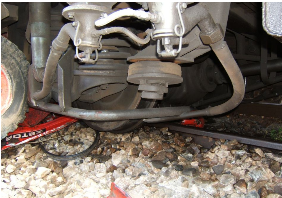
Obr. č. 7: Pohled na vykolejenou první nápravu HDV
