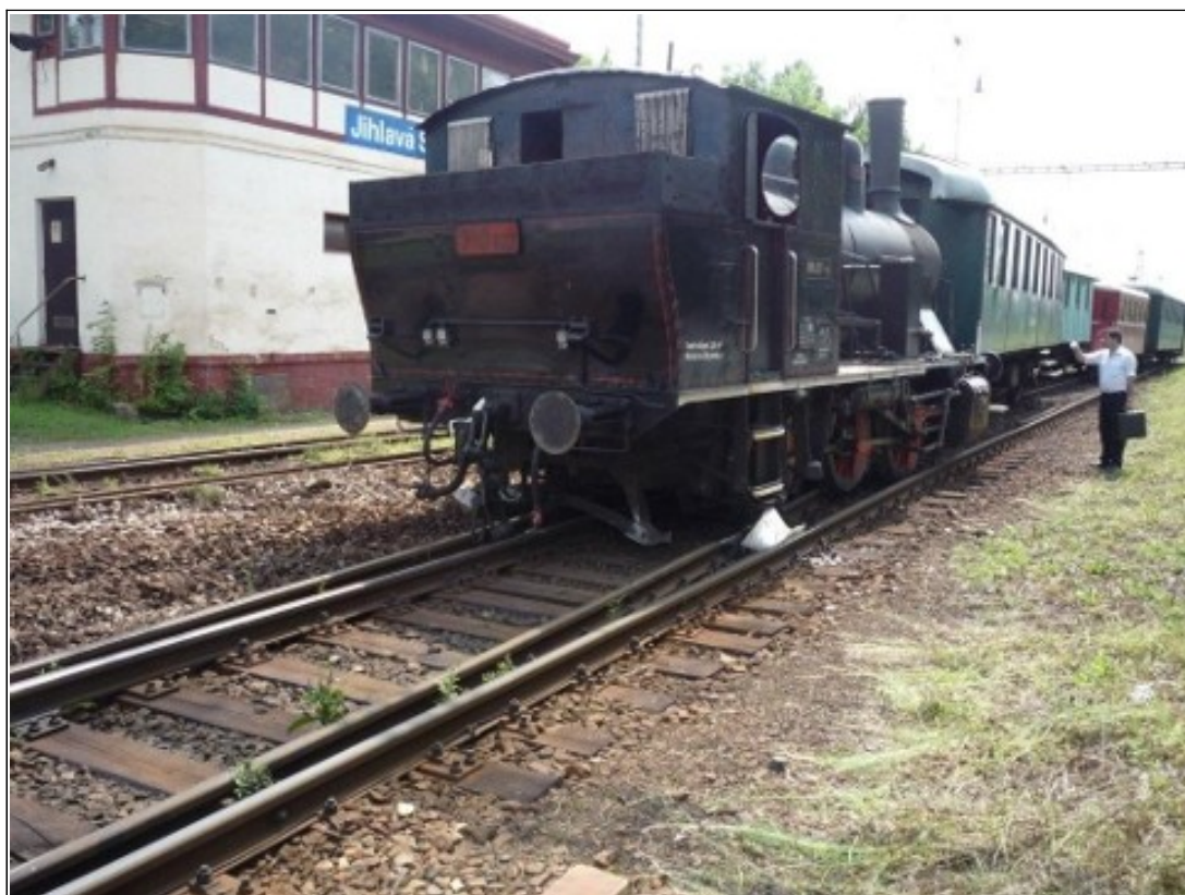
Foto 4: Druhá část vlaku po vykolejení na zhlaví žst. Jihlava
