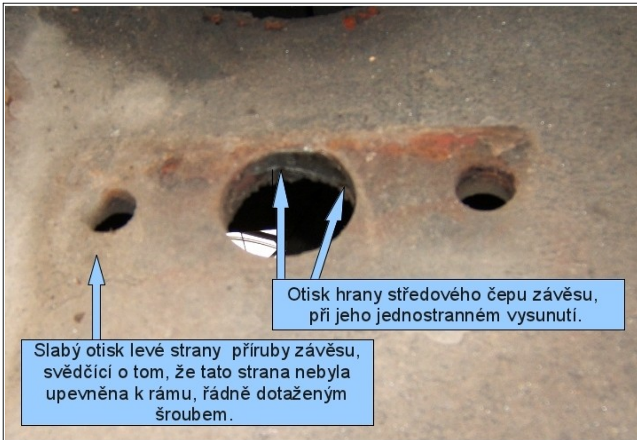
Obr. č. 3: Otisk příruby závěsu pružnice na rámu lokomotivy
