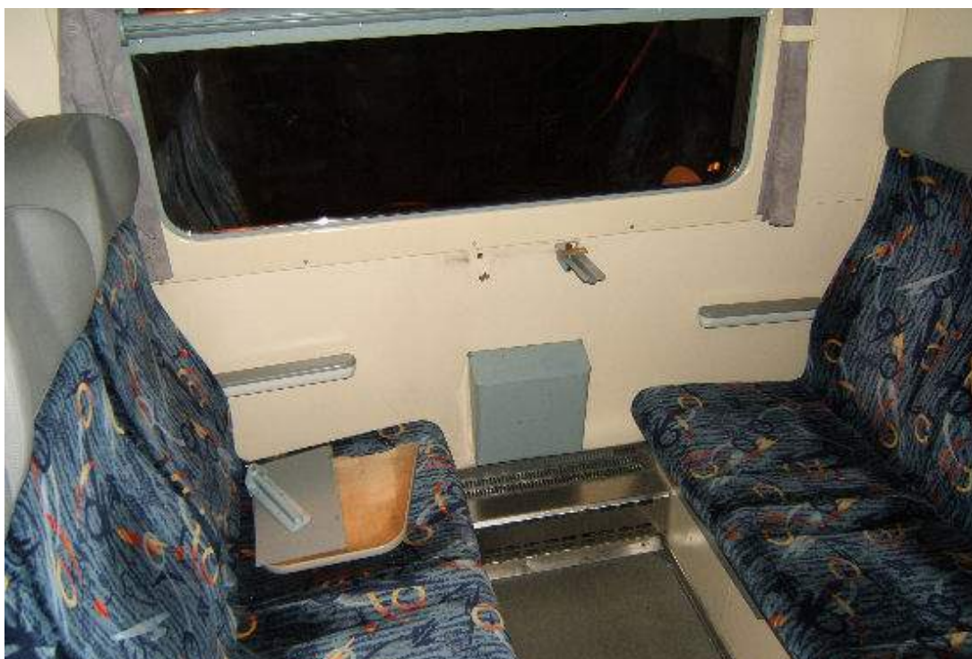
obrázek 29: interiér DV 914.030-2 při komisionální prohlídce, na stolku položen odpadlý kryt sloupku sedačky
