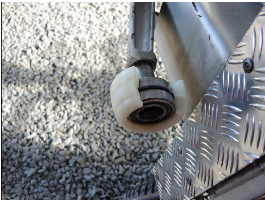
Obr. č. 5: Pohled na silonové kolečko spínacího aparátu DV č. 29 poškozené vylomením cca 1/4 materiálu.
