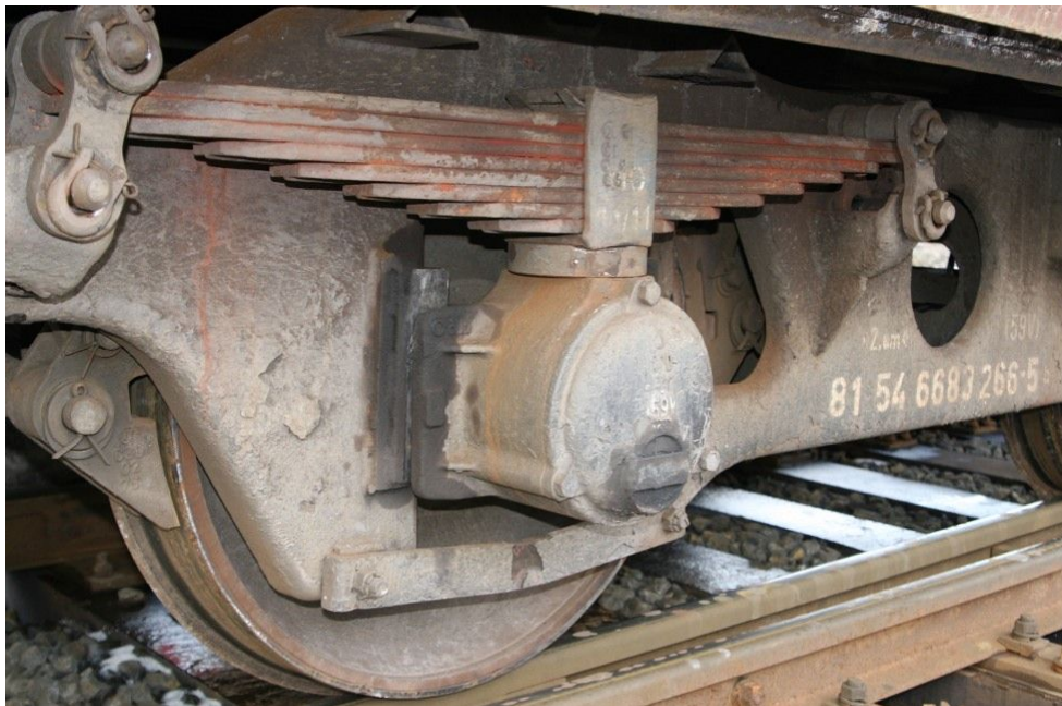
Obr. č. 7: Chybějící brzdové zdrže a stopy po vykolejení na voze Falls 81 54 6683 266-5
