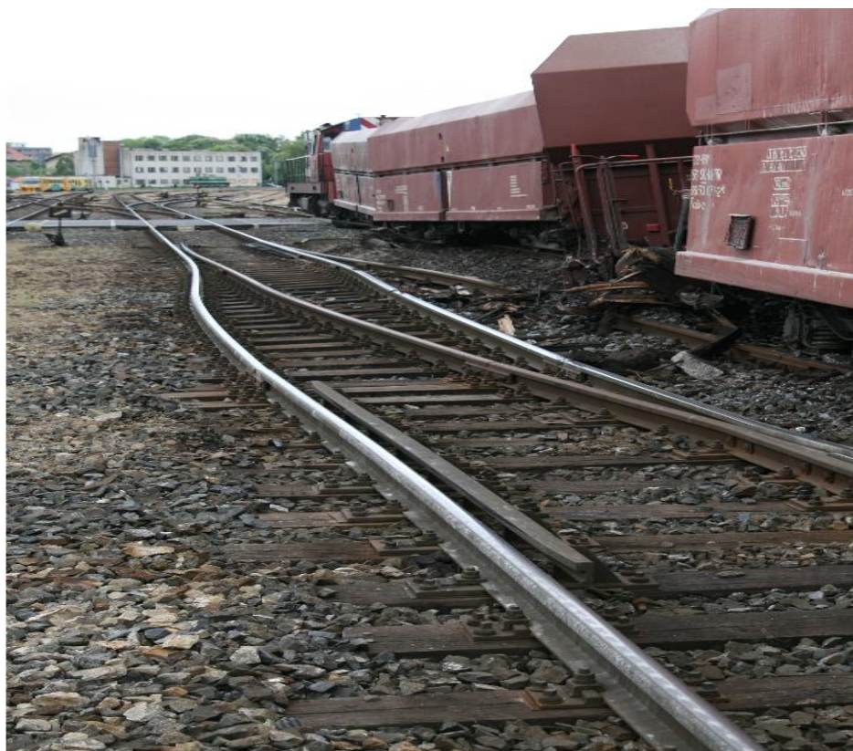
Obr. č. 12: Pohled na vykolejená TDV
