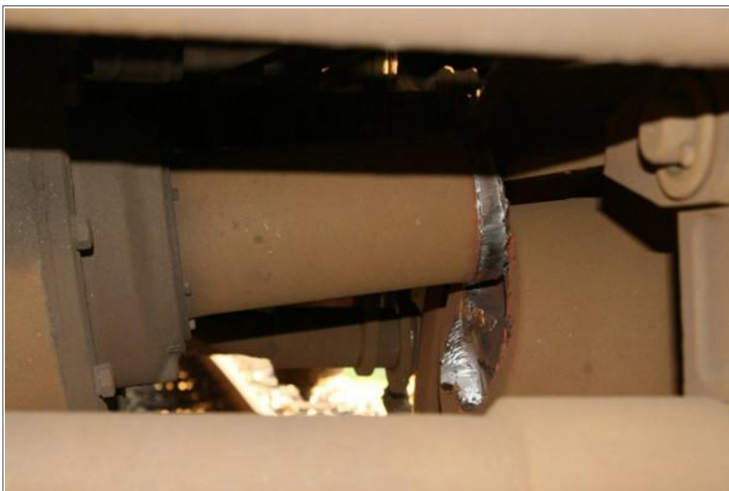
Obr. č. 17: Pohled na lom nápravy a levé kolo
