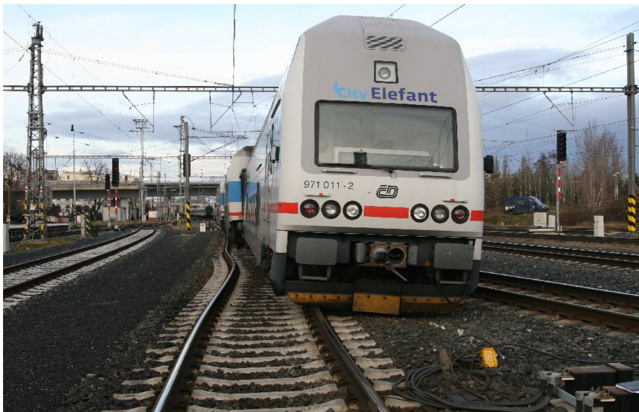
Foto 1: Postavení vykolejené soupravy
