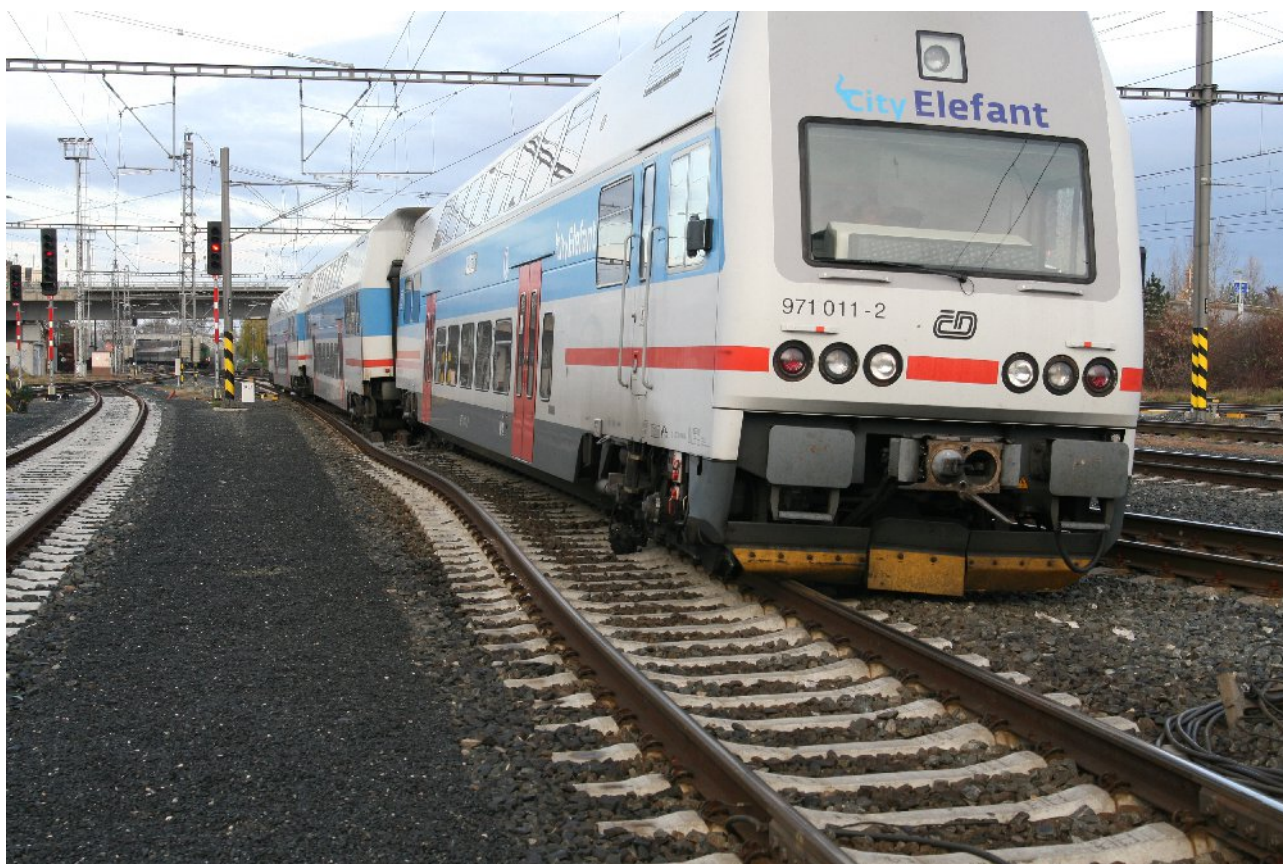
Foto 2: Postavení vykolejené soupravy
