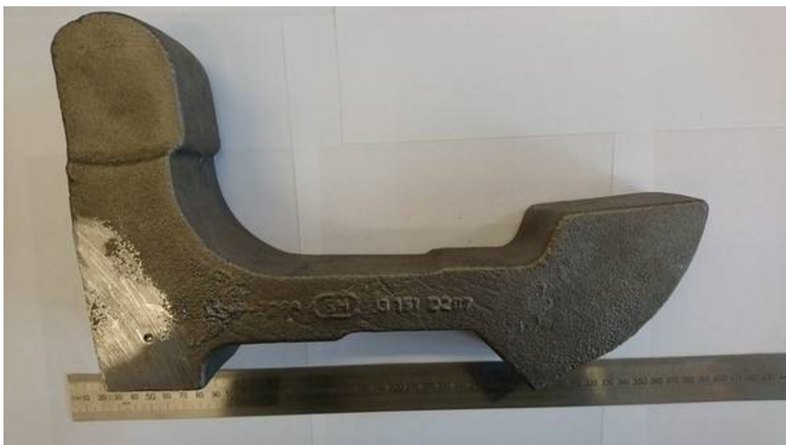
Obr. č. 20: Celkový pohled na odlitek háku z boční strany
