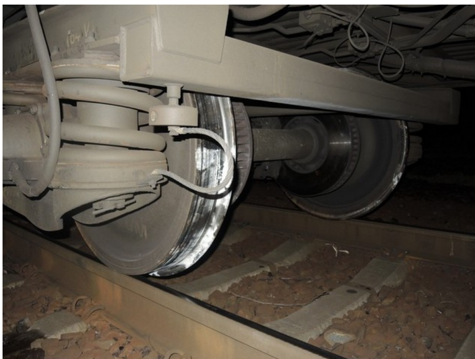
Obr. č. 8: Poškození a znečištění jízdnic kol dvojkolí u předního podvozku TDV č. 61 54 20-70 031-7
