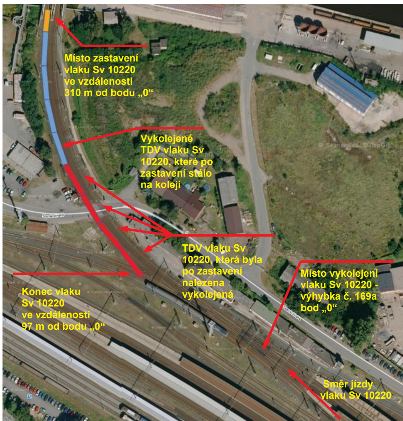
Obr. č. 2: Schéma místa vzniku MU
