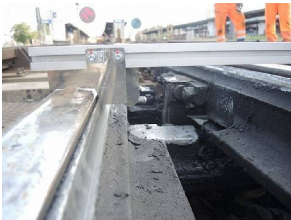
Obr. č. 11: Měření prostorovou šablonou PŠR-3 na výhybce č. 169a a stopy po jízdě okolů kol drážních vozidel na jazyku
