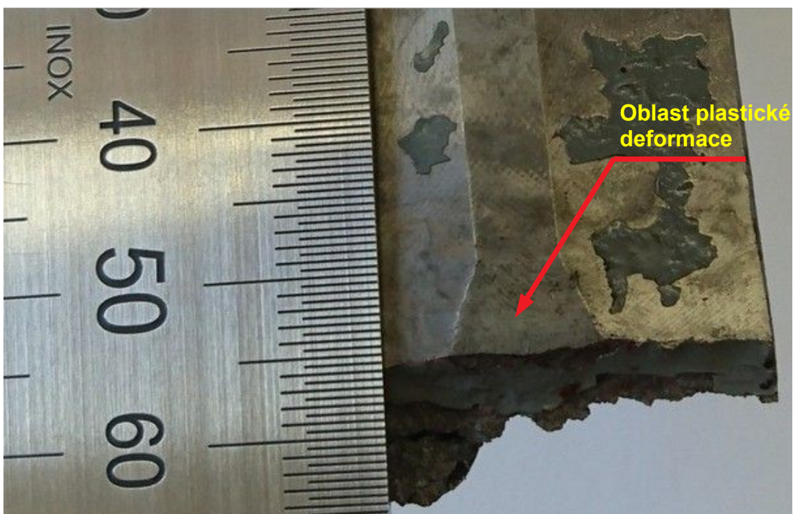
Obr. č. 14: Plastická deformace na konci zešíkmení na horní stěně zlomeného závěrového háku pravého vnitřního ohnutého jazyka Zdroj: DI
