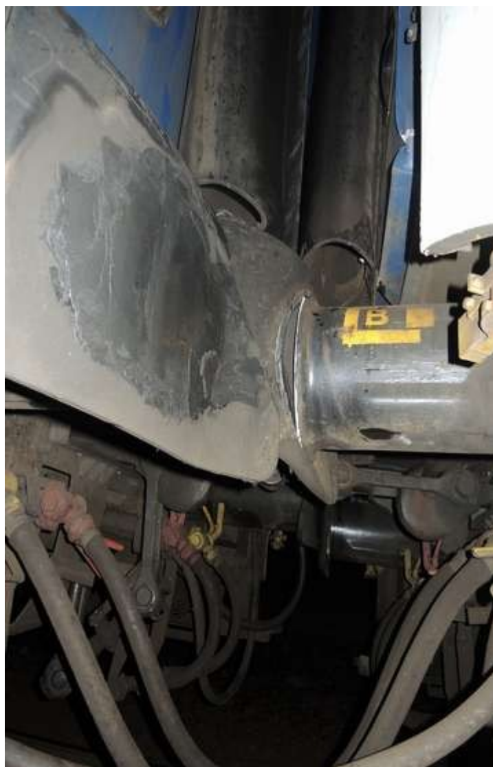
Obr. č. 7: Tzv. „přenárazníkování“, a to mezi 4. a 5. TDV Zdroj: DI
