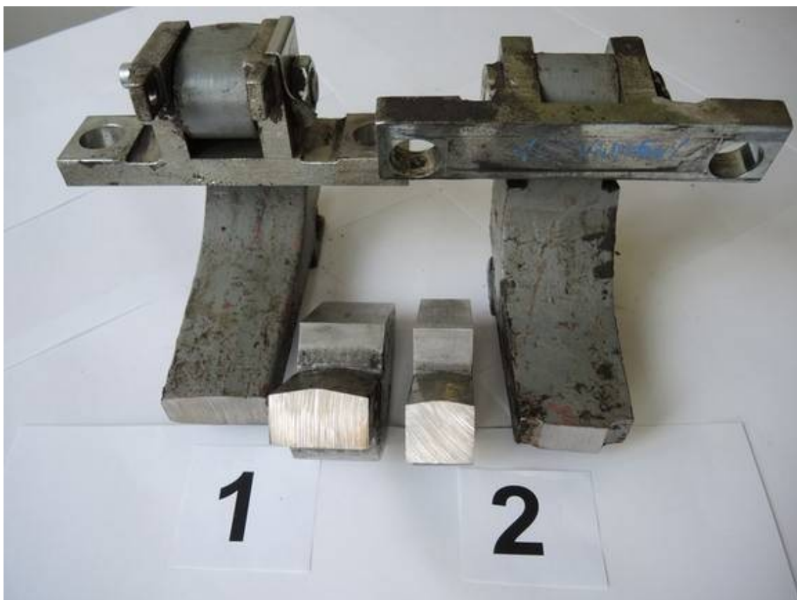
Obr. č. 19: Pohled na závěrové háky použité v čelistovém výměnovém závěru křížovatkové výhybky č. 169a. Závěrový hák umístěný vlevo označený jako „1“ je tzv. „vnější“ a je vyráběn jako zápusťkový výkovek. Závěrový hák umístěný vpravo označený jako „2“ je tzv. „vnitřní“, je zeslabený a je vyráběn jako odlitek. Zdroj: DI
