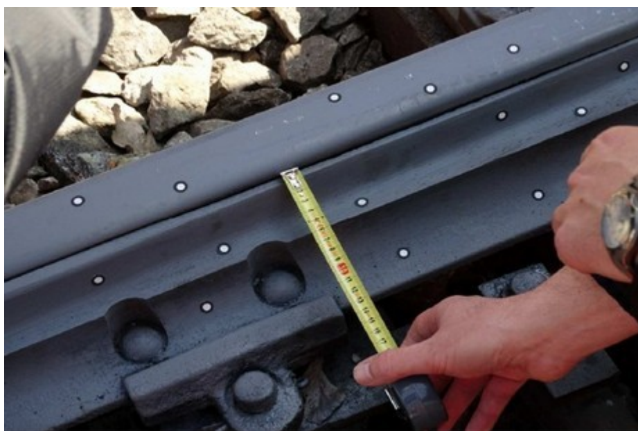
Obr. č. 6: Tloušťka jazyka, při které dojde ke kontaktu se šablonkou -17 mm, byla naměřena téměř 6 mm.
