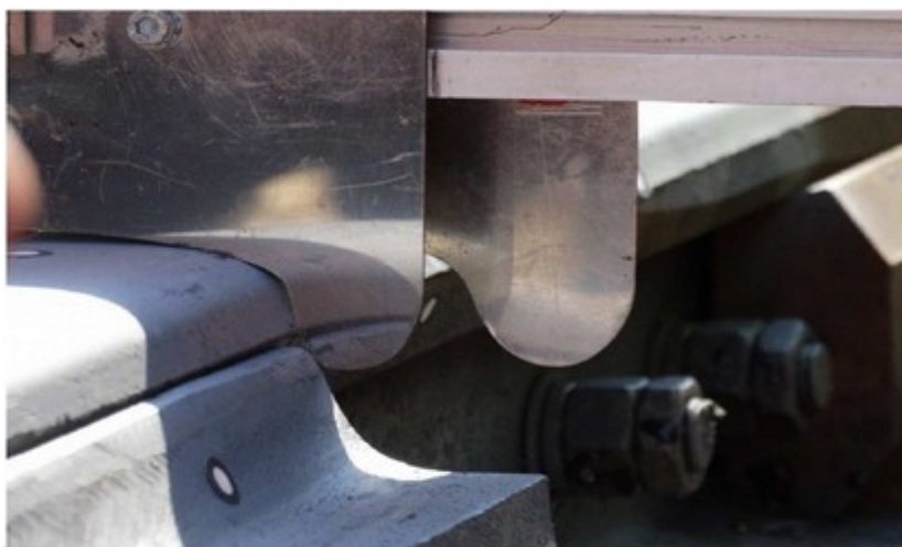
Obr. č. 3: Měření šablonou PŠR-3. Jízdní obrys qR = 6,5 narazí na hrot jazyka.
