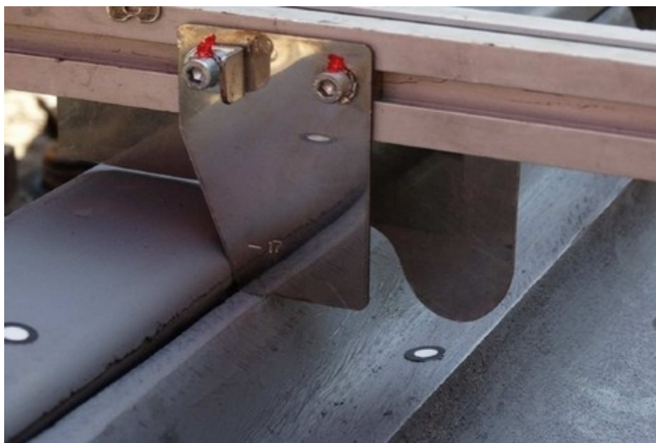
Obr. č. 5: Měření šablonou PŠR-3. Nevyhovující výškový stav jazyka je rovněž patrný z posouzení šablonkou -17 mm
