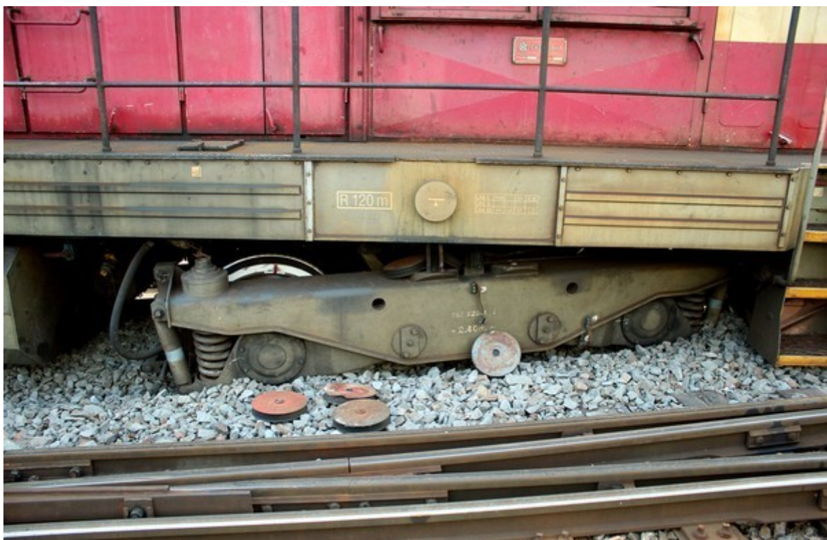
Obr. č. 12: Detail vykolejení HDV - pravá strana ve směru jízdy
