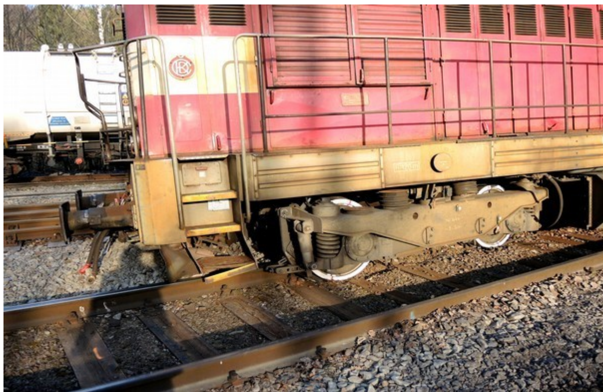
Obr. č. 13: Detail vykolejení HDV - levá strana ve směru jízdy
