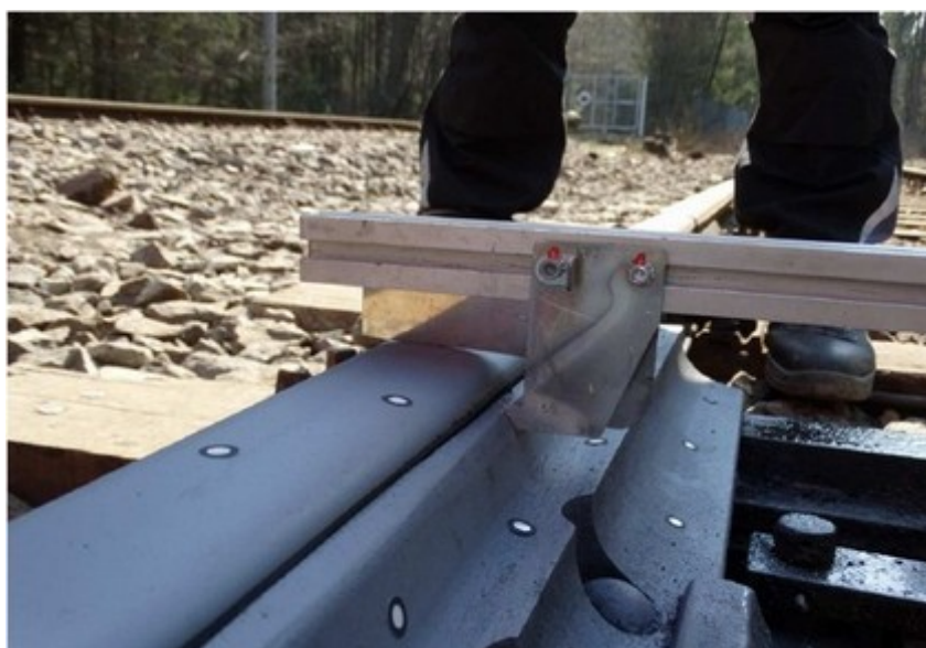
Obr. č. 4: Měření PŠR-3. Přibližná poloha řezu, kde jazyk vyhoví na šablonu 55°
