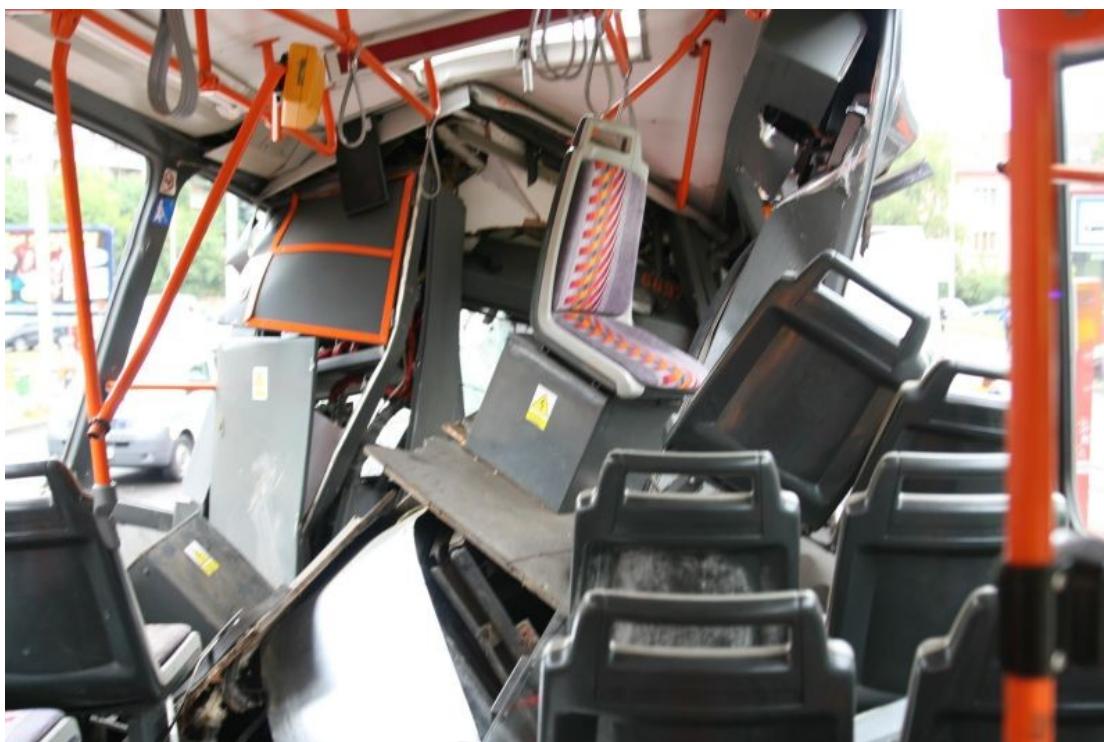
Foto 5: Deformovaný interiér DV T6A5 ev. č.: 8697
