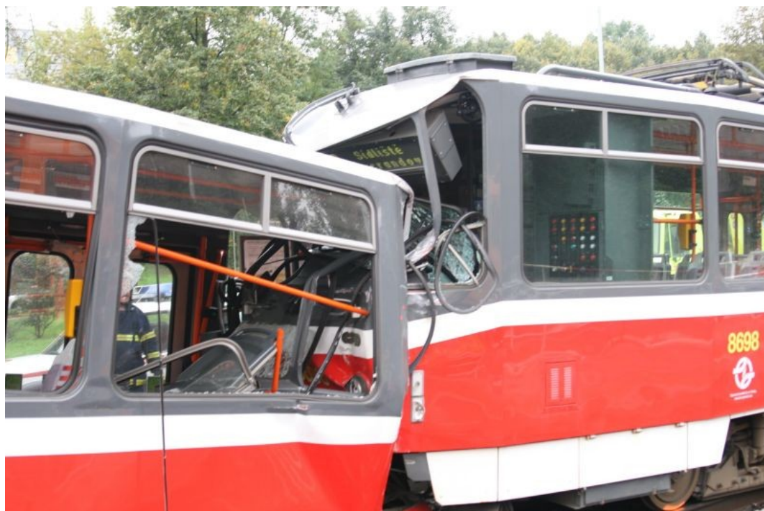
Foto 4: Deformace DV TVL linky 20 pořadí 8
