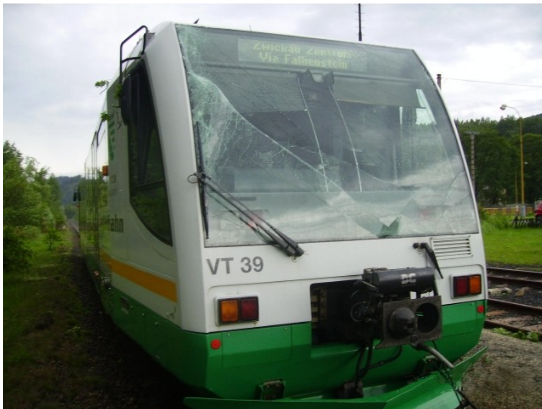
Foto 1: Rozbité čelní sklo zadního stanoviště motorové jednotky
