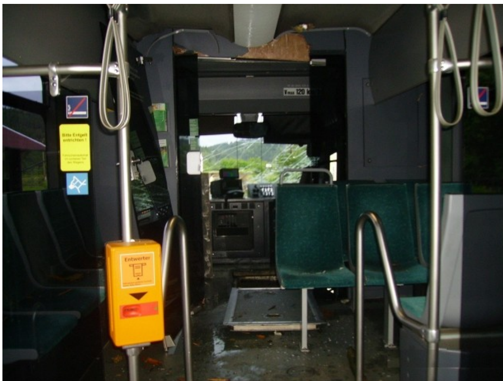
Foto 2: Poškozený interiér motorové jednotky
