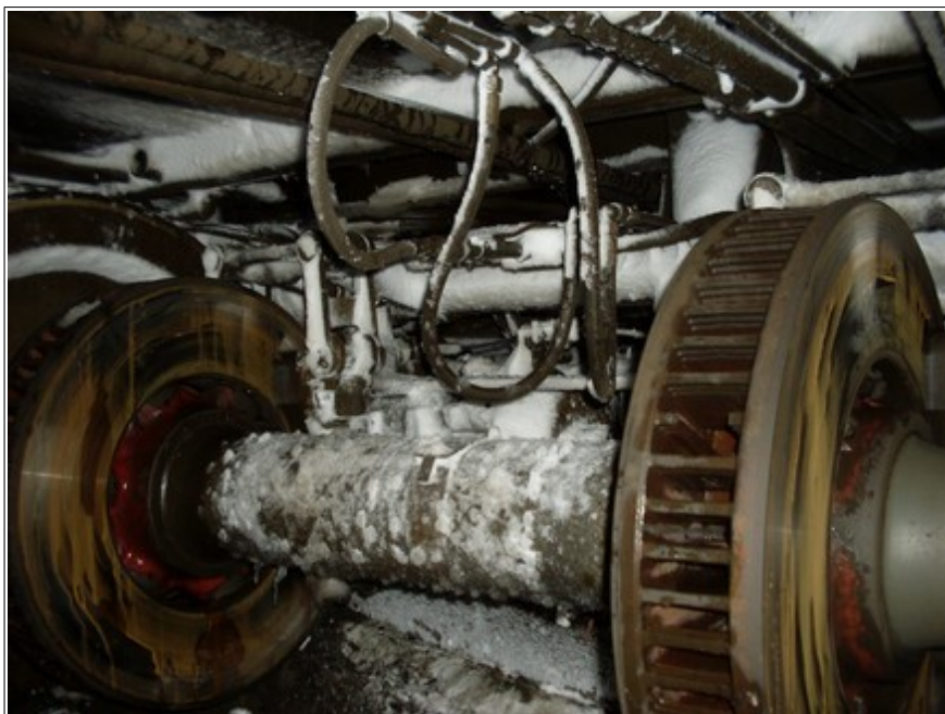
Obr. č. 6: Pohled na brzdové kotouče 2. nápravy ŘDV 80-29 007-9 po MU. Zdroj: DI
