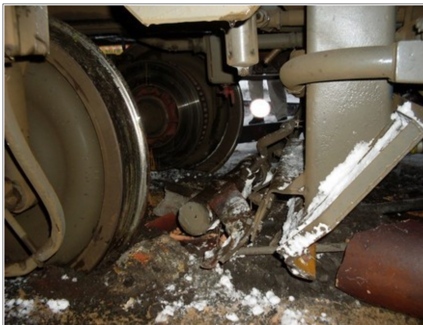
Obr. č. 5: Pohled na vykolejené dvojkolí a levý brzdový kotouč 1. přední nápravy ŘDV 80-29 007-9 po MU. Zdroj: DI
