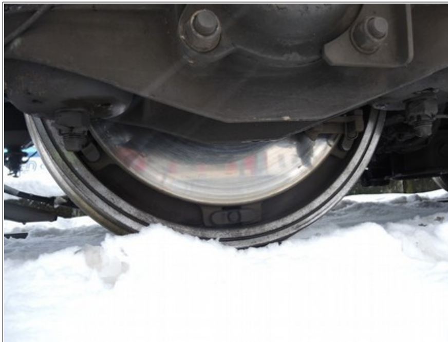
Obr. č. 7: Pohled na pravé kolo a vnější brzdový kotouč 4. nápravy HDV 843.007-6 po MU. Zdroj: DI
