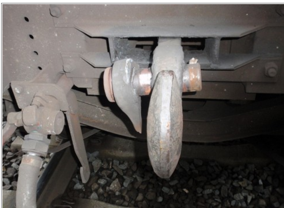
Obr. č. 8: Poškozená šroubovka TDV Shimmns 35 81 4673 285-6, řazeného jako 23. TDV za HDV vlaku Nex 54285.
