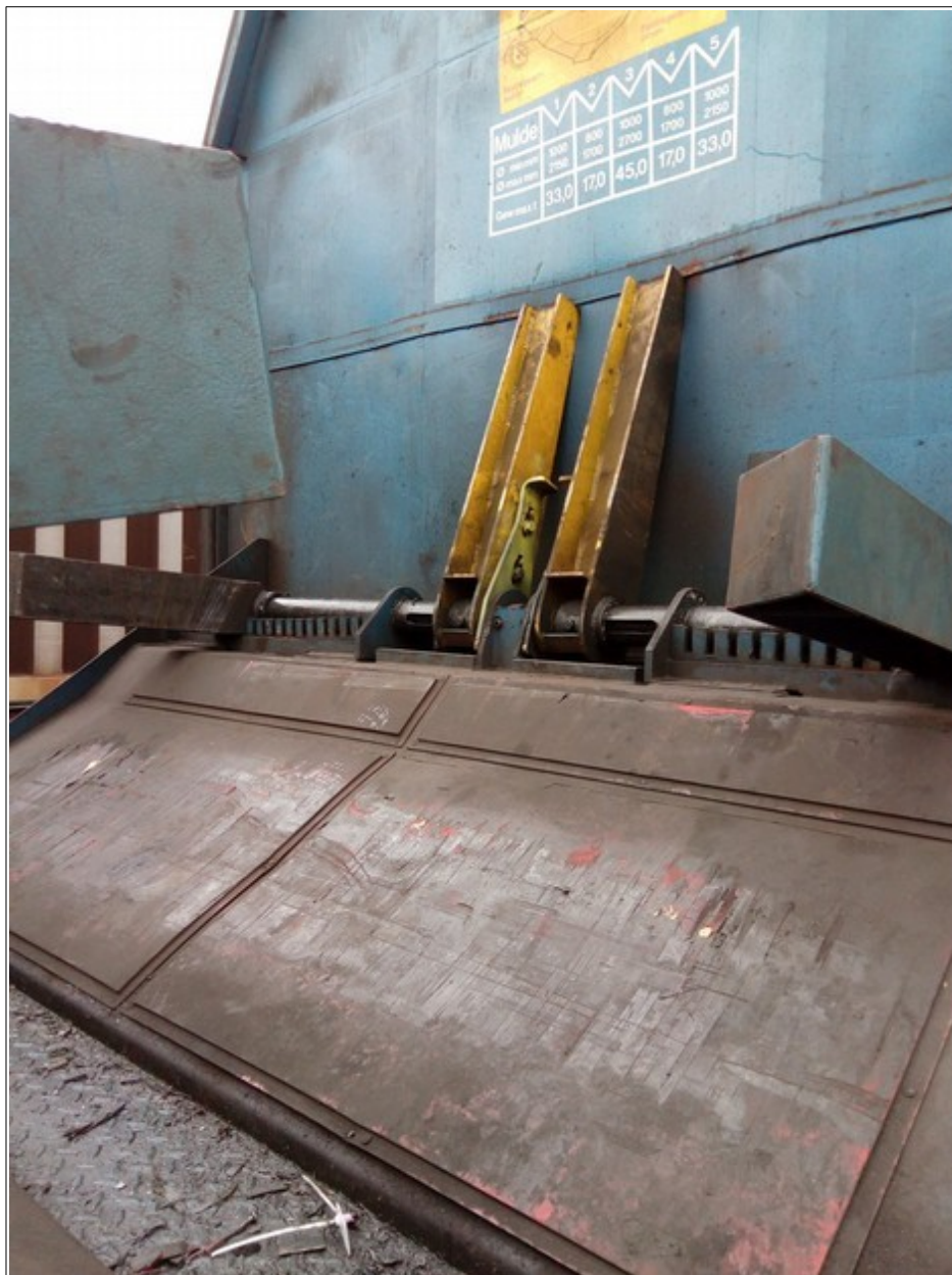
Obr.č. 6: Nezajištěná ramena přední prázdné „muldy“ TDV Shimms 35 81 4673 285-6.
