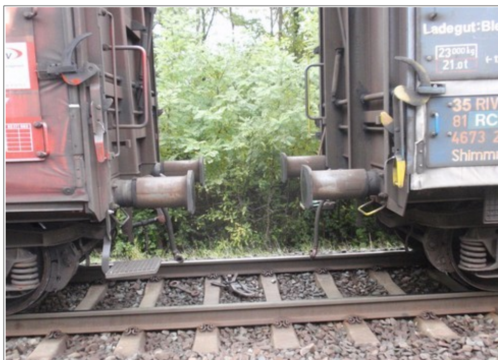
Obr. č. 7: Místo násilného rozpojení mezi 22. a 23. TDV za HDV vlaku Nex 54285.
