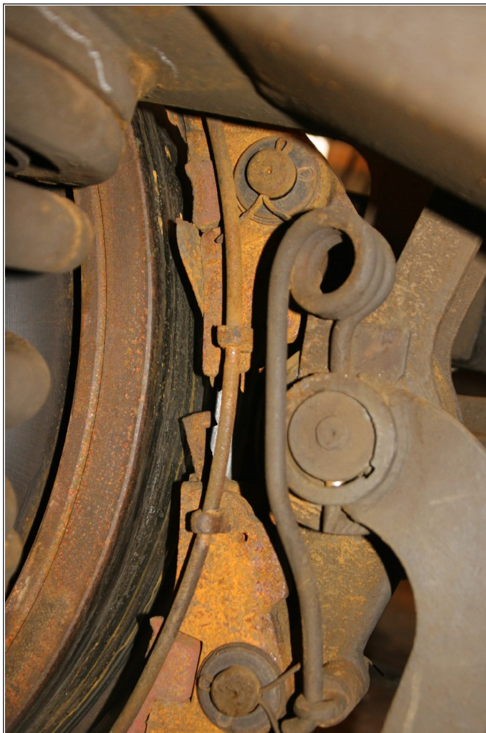
Foto 5: pohled na opotřebované brzdové špalíky.
