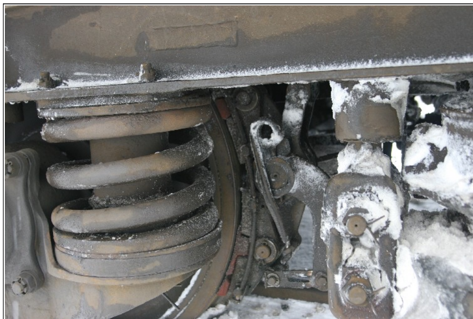
Foto 6: pohled na zbarvení brzdových špalíků.
