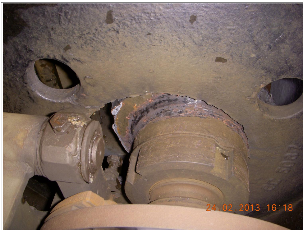
Obr. č. 8: Detailní snímek zlomeného pravého kola v. č. VS141, pořízený 22 minut po vzniku MU.
