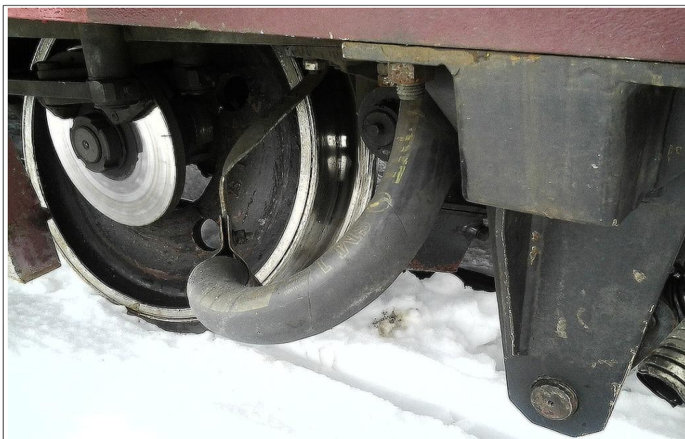
Obr. č. 7: Zlomené pravé kolo v. č. VS141 bezprostředně po vzniku MU.
