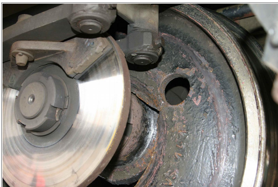
Obr. č. 4: Zlomené pravé kolo v. č. VS141, jehož disk byl vylomen vně směrem k brzdovému kotouči TAKB.
