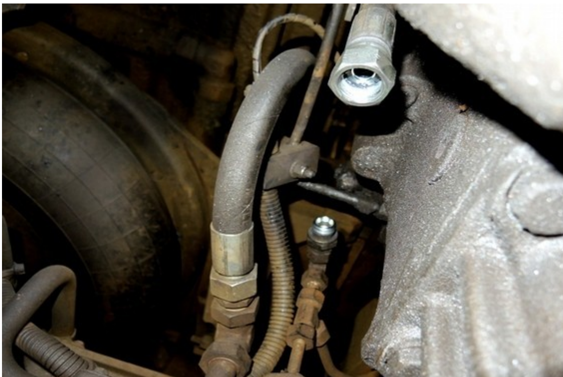
Obr. č. 12: Rozpojená hadice B17 – příčina zastavení vlaku Os 24948 na trati
