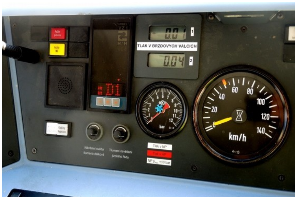
Obr. č. 7: Tlak v brzdových válcích po MU (nahore uprostřed)
