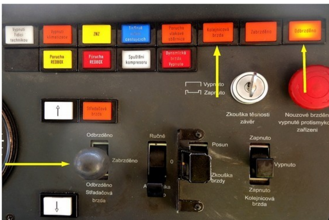
Obr. č. 9: Sřadačová brzda v poloze „Zabržděno“, kolejnicová brzda v poloze "Odbžděno"
