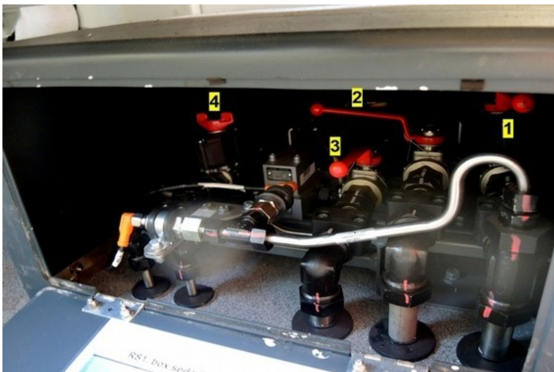
Obr. č. 4: Skříň WE 2 s brzdovými ventily pro podvozek 2 (stav po MU)
