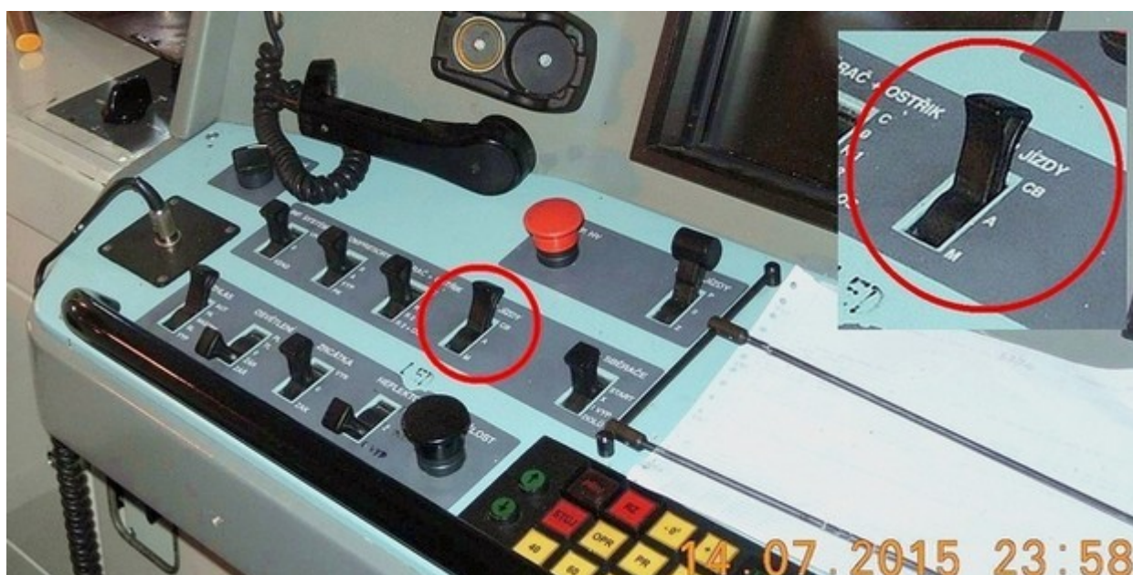
Obr. č. 19: Páčka ovladače režimu jízdy nalezena dne 14. 7. 2015 ve 23:58 h v poloze „CB“.
