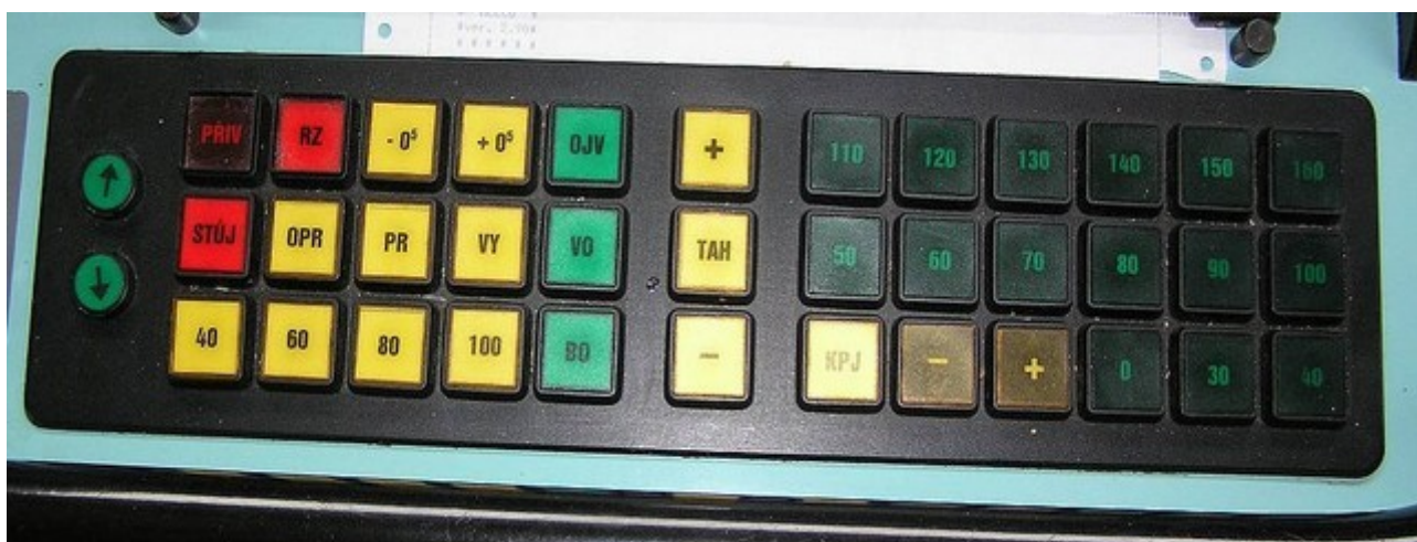
Obr. č. 25: Klávesnice ARR&AVV. V pravé části jsou tlačítka pro přímé zadání rychlosti. Tlačítka v levé polovině jsou využívána při jízdě s aktivním režimem „CB”. Zdroj: DI
