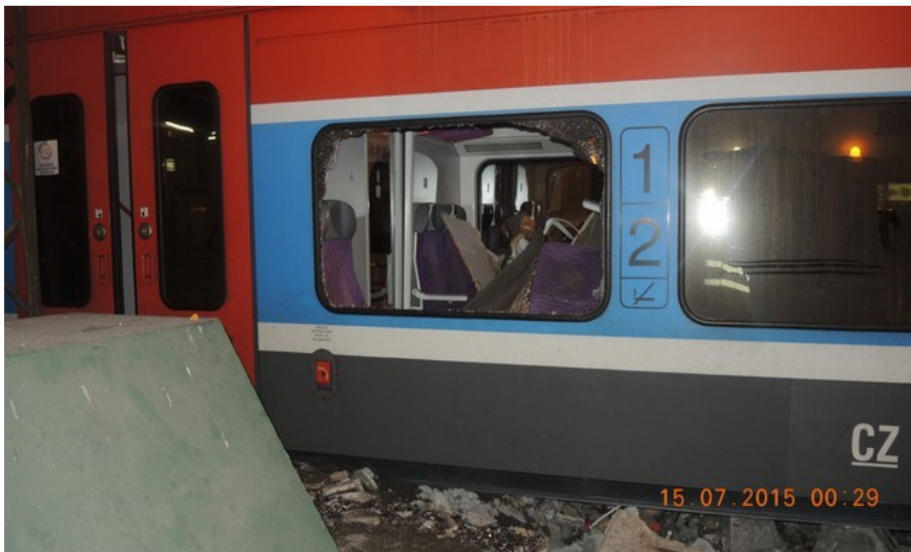
Obr. č. 24: K poškození okna v prostoru pro cestující v HDV došlo vlivem MU.
