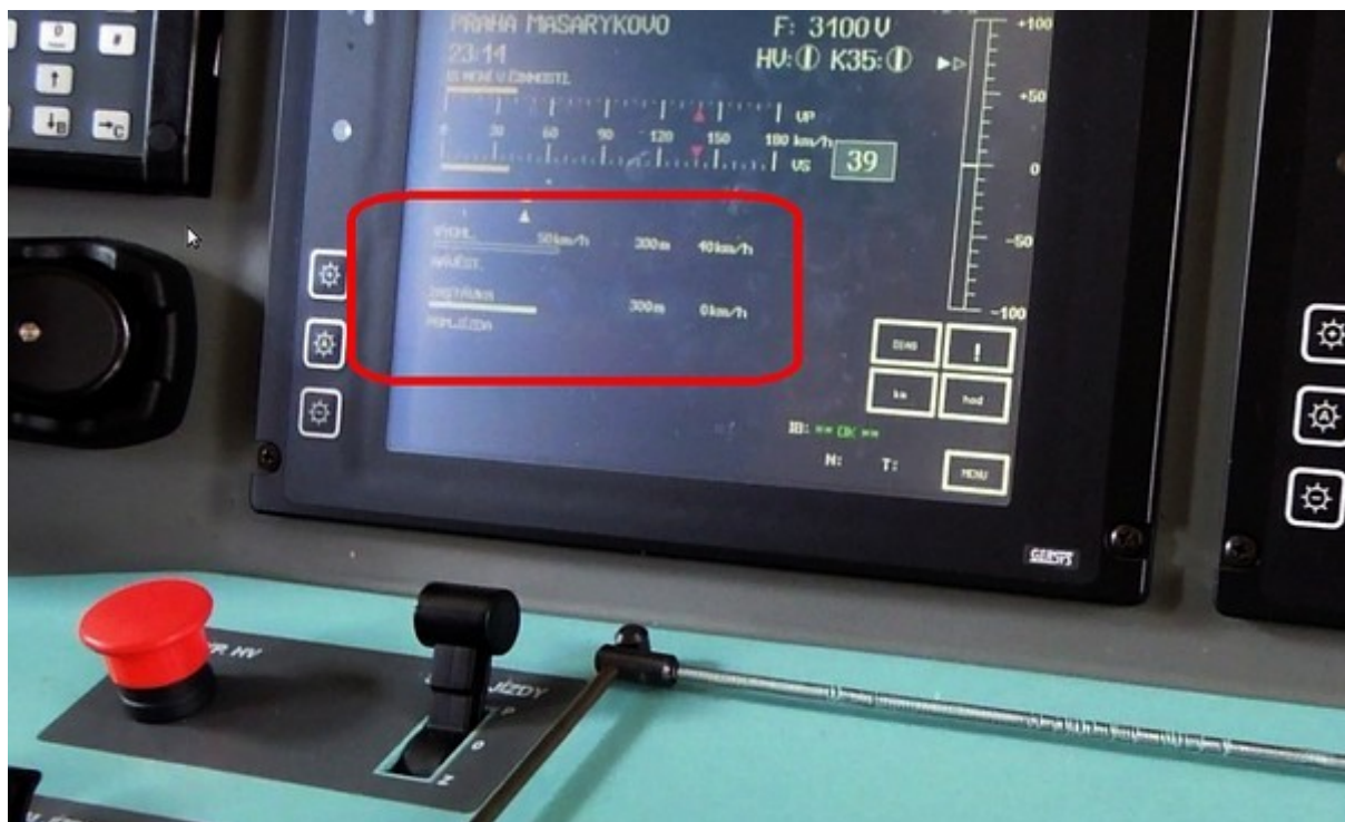
Obr. č. 17: Při aktivním režimu „CB“ je zobrazena v označeném poli informace o vzdálenosti k místu automatického zastavení a zároveň k návěstidlu Lc3 (v tomto případě 300 m)
