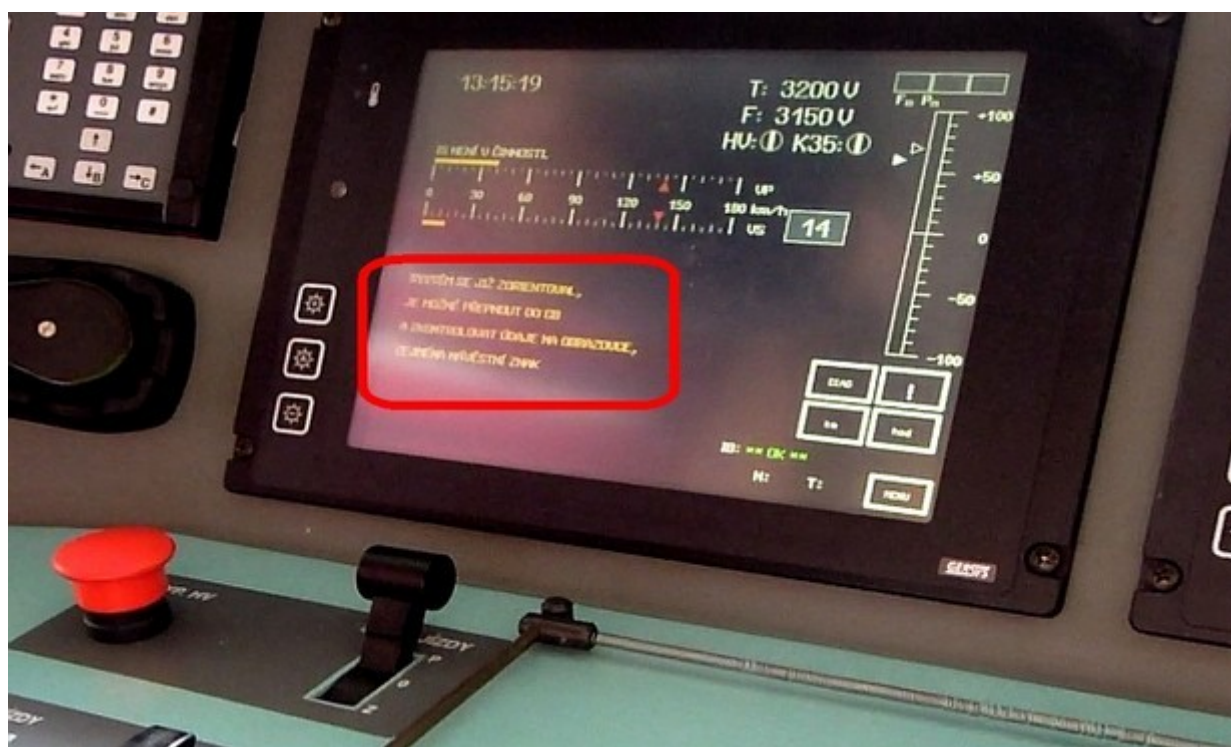
Obr. č. 18: Při aktivním režimu „A“ je zobrazen v označeném poli čtyřřádkový text: „System se již zorientoval, je možné přepnout do „CB“ a zkontrolovat údaje na obrazovce, zejména návěstní znak.“ Zdroj: DI
