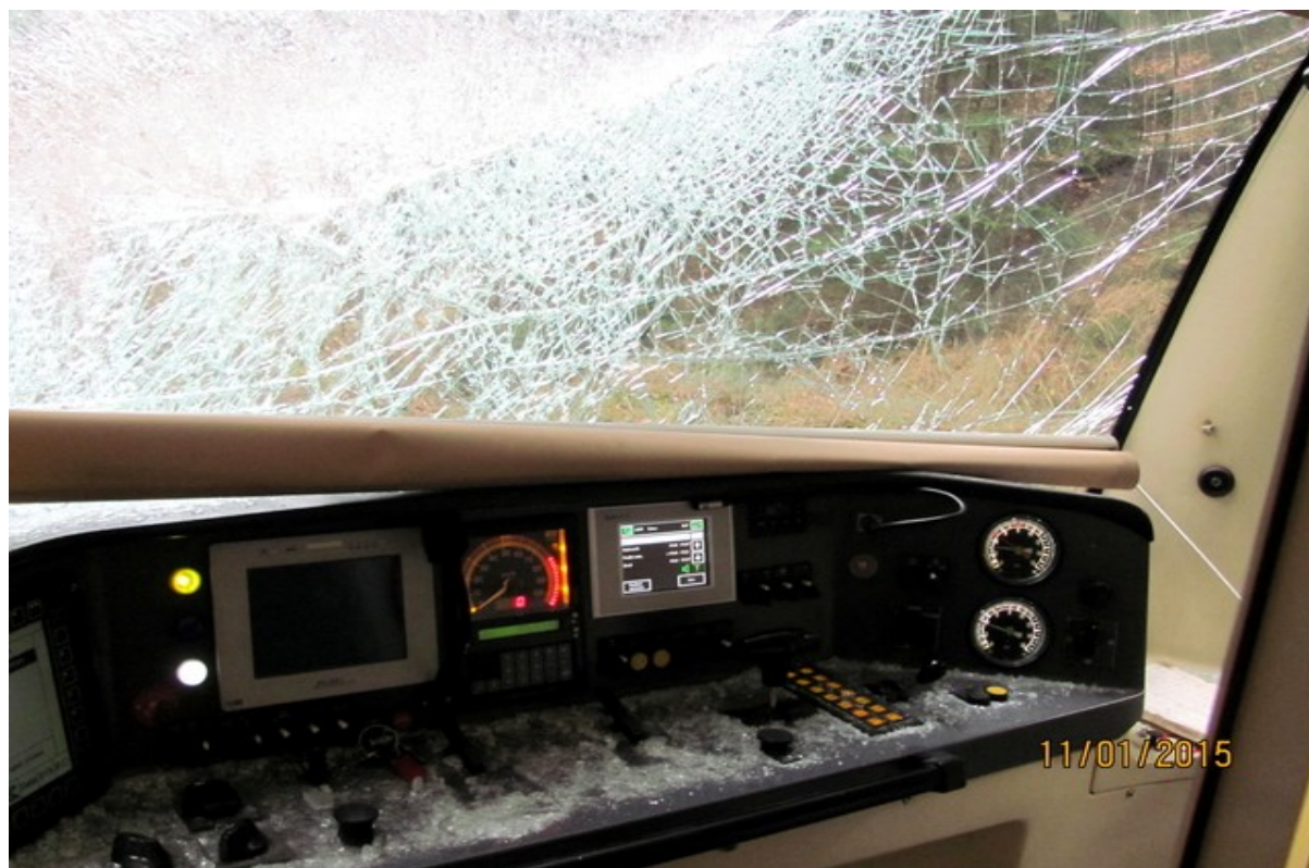
Obr. č. 8: Poškození stanoviště strojvedoucího
