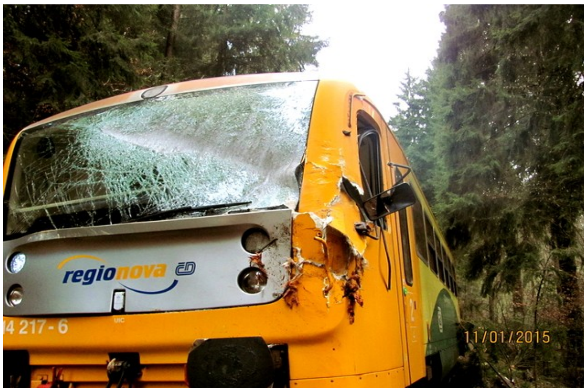
Obr. č. 7: Poškození HDV
