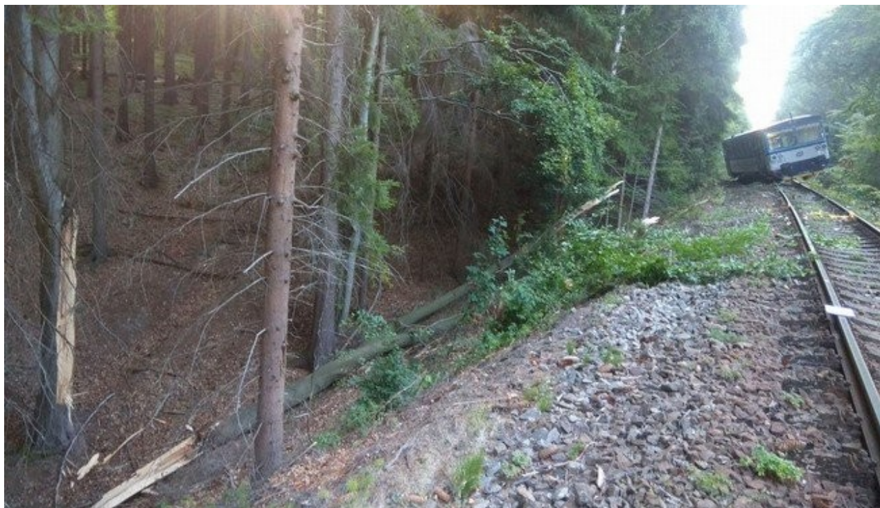
Obr. č. 5: Pohled na odlomenou dolní a střední část stromu a vykolejený vlak
