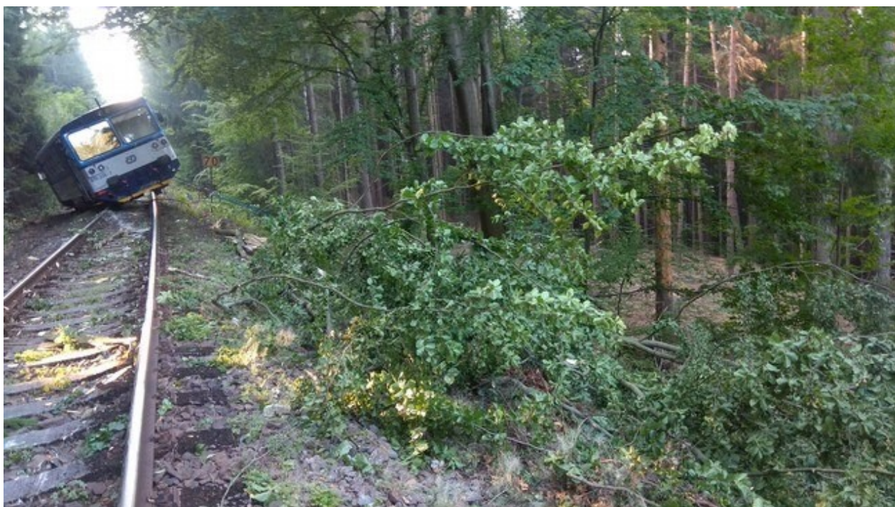
Obr. č. 6: Pohled na odlomenou horní část stromu a vykolejený vlak
