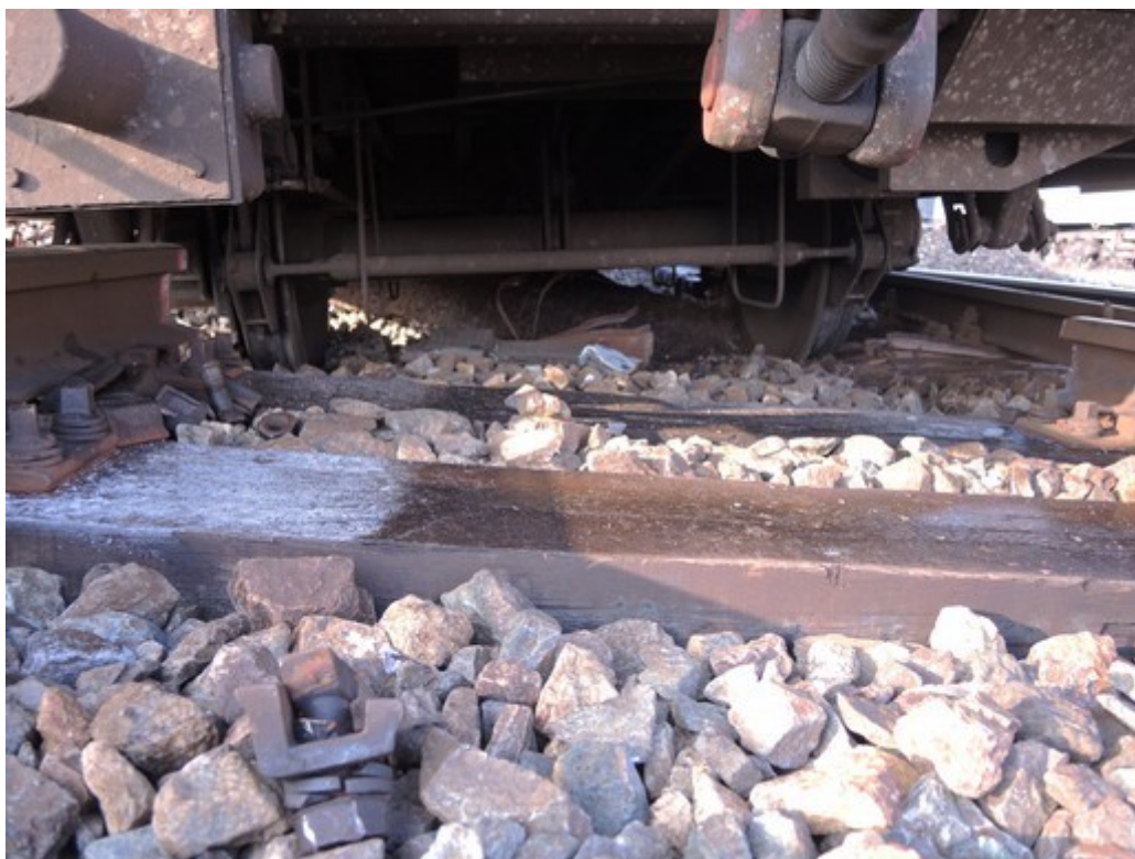
Obr. č. 6: Bod „0“ – odříznutý koncový styk výhybky č. 202b a vykolejená poslední náprava prvního vozu
