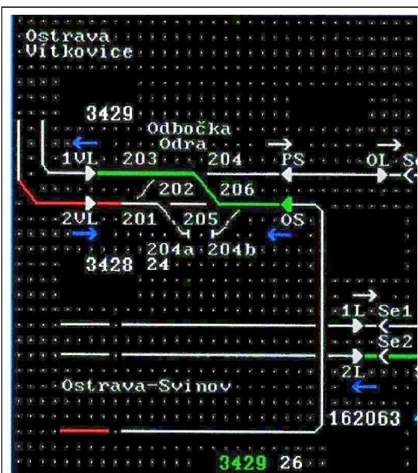
Obr. č. 5: Stav indikačních prvků SZZ odb. Odra, zobrazující přítomnost vlaku Os 3428 v KO za hlavním (vezdovým) návštěvídlem 2VL – stav bezprostředně po vzniku MU
