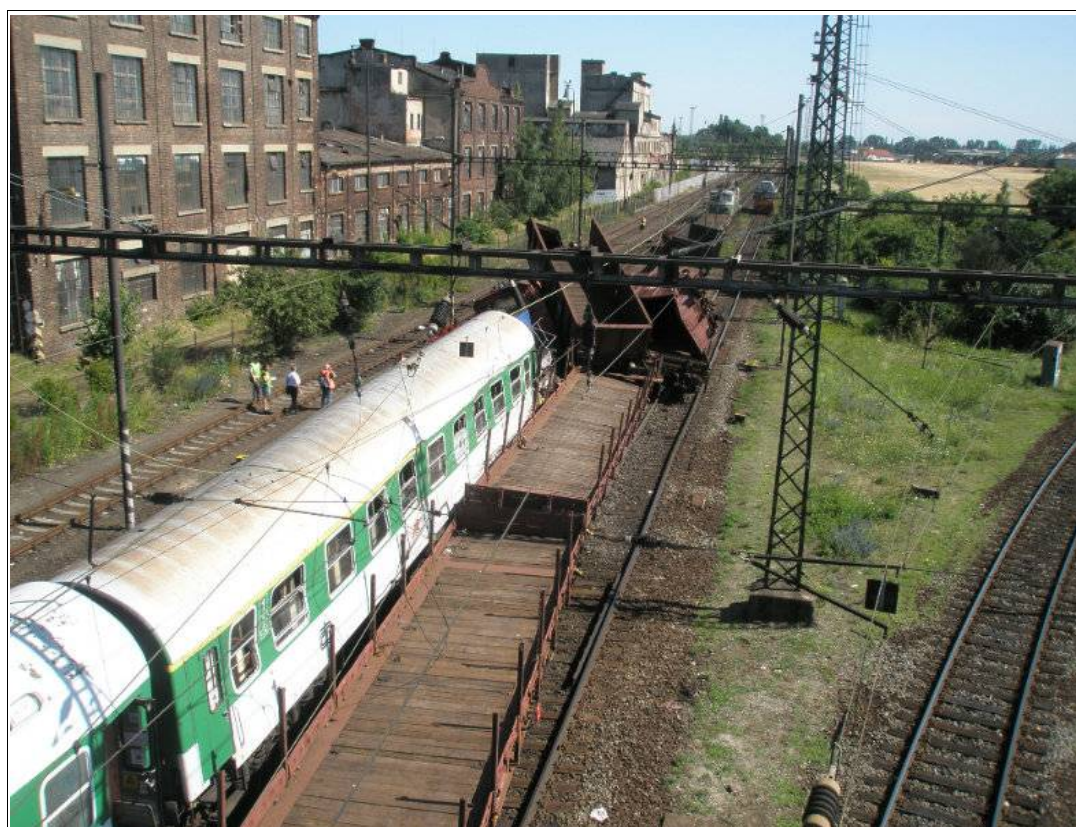
Obr 7.3: Vykolejená DV vlaku Rn 53033 a 1. posunové zálohy
