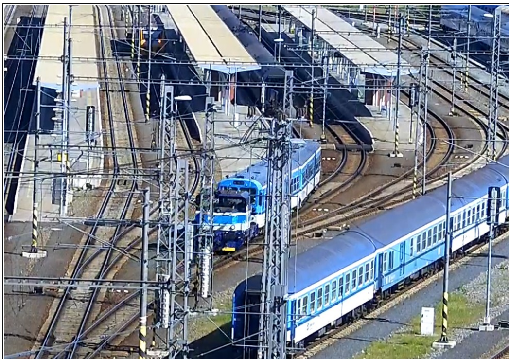
Obr. č. 3: Snímek z kamerového systému zachycující sunutý posunový díl v prostoru srdcovky výhybky č. 38 žst. Olomouc hl. n. Zdroj: SŽ
