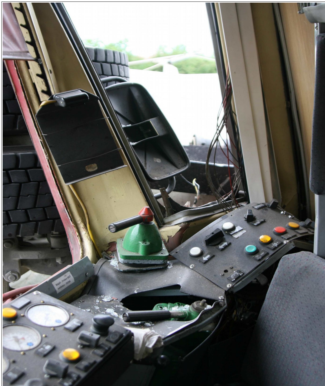
Obr. č. 3: Destrukce předního stanoviště HDV po MU.
