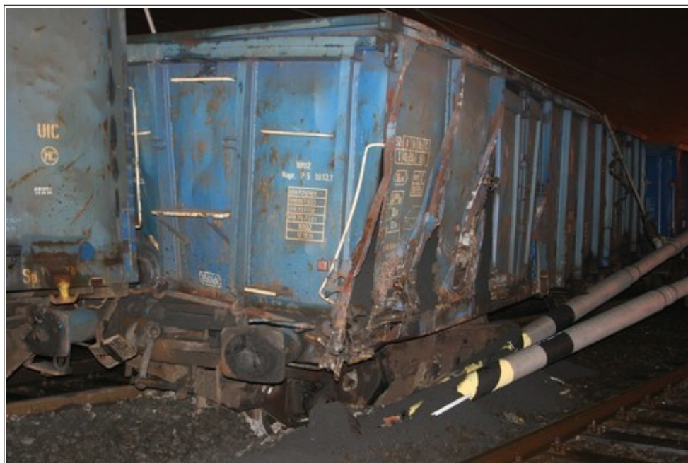
Obr. č. 5: Poškozené a vykolejené TDV u trakční podpěry č. 106.
