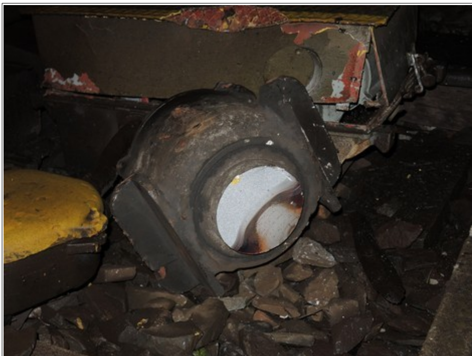
Obr. č. 3: Ulomený čep nápravy s ložiskovou skříňí TDV 82 51 597 6133-7 ležící po vzniku MU v prostoru výhybky č. 105.
