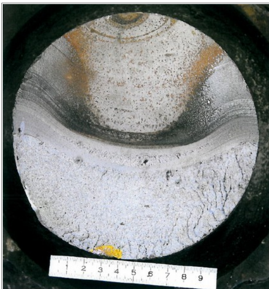
Obr. č. 6: Detail lomové plochy čepu nápravy.
