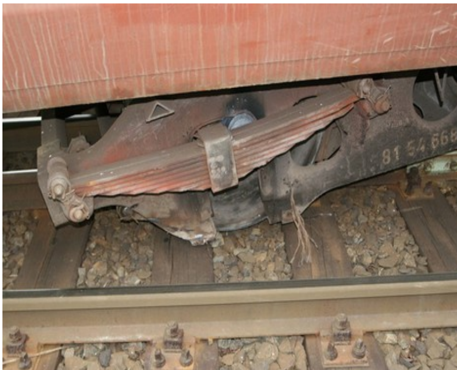
Obr. č. 3: Vykolejený podvozek „a“
