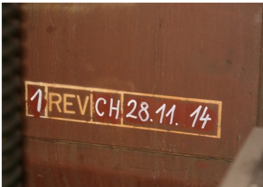
Obr. č. 8: Vyznačení provedení technické kontroly na vykolejeném voze
