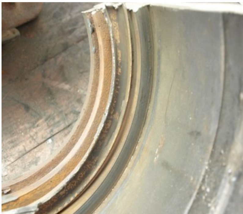
Obr. č. 11: Ložisková skříně a labyrint beze stop po zbytcích shořelého maziva
