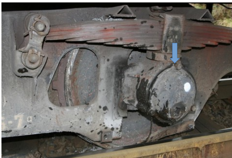
Obr. č. 4: Poškozené víko ložiskové skříně a únik maziva na podvozku „a“ (vpravo ve směru jízdy)
