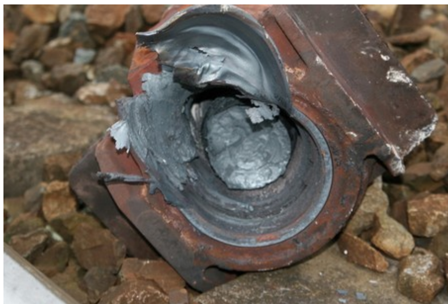
Obr. č. 6: Ložisková skříň na místě vykolejení
