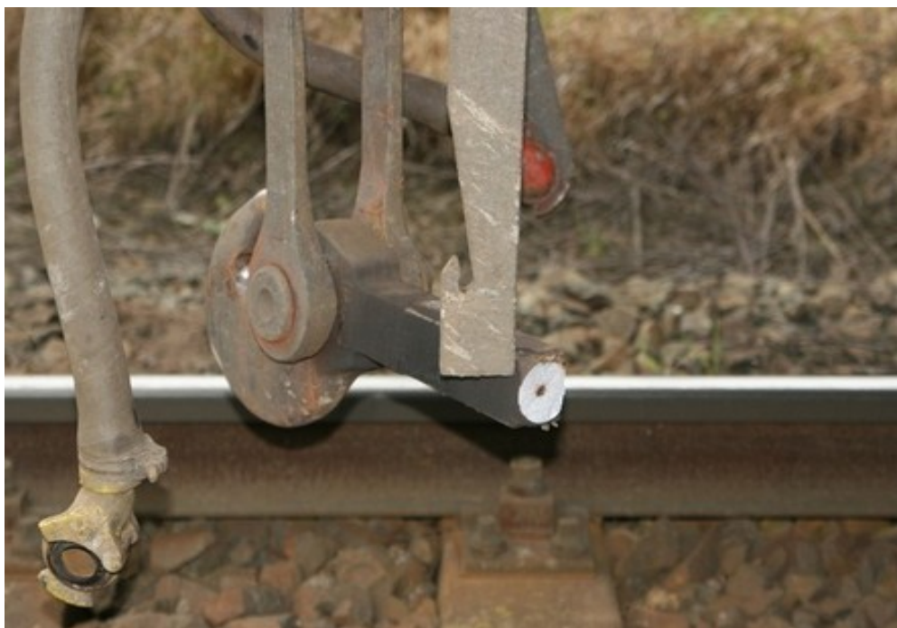
Obr. č. 2: Přetržený hák spřáhlového ústrojí 14. vozu
