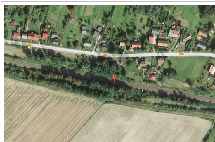
Obr. č. 3: Místo vzniku MU – ze snímku je dobře patrné, že TK jsou vedeny v zářezu a svahy přiléhající k trati jsou porostlé bujnou vegetací.
