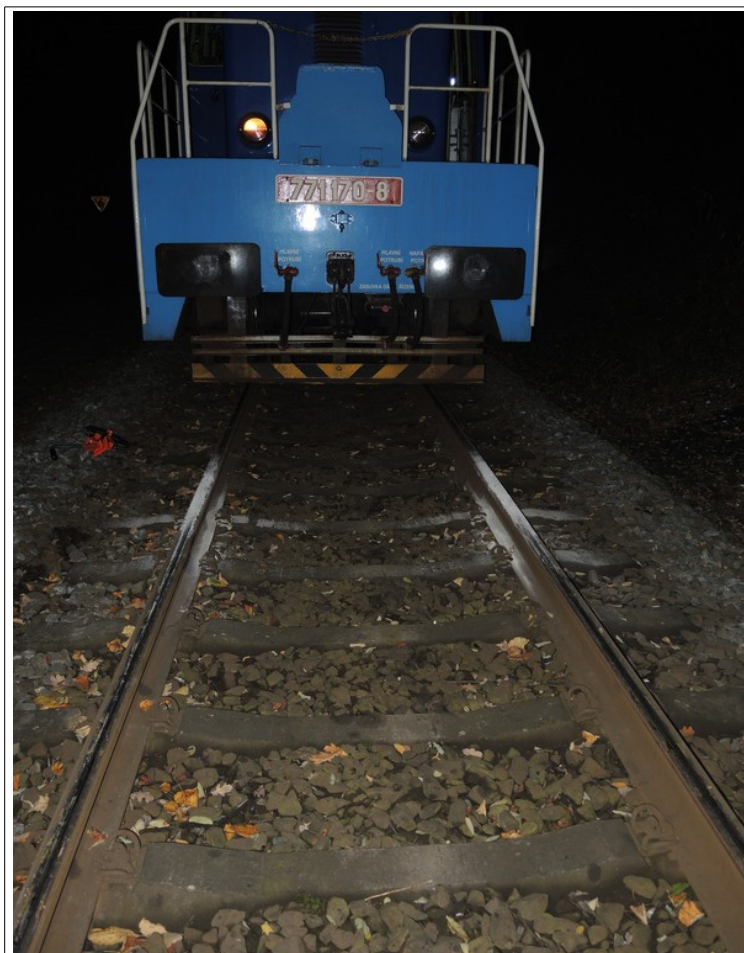
Obr. č. 2: Písek na temenech kolejnic 1. TK mezi km 289,0985 a 289,0971, který použil strojvedoucí vlaku Pn 47850 při opakovaných neúspěšných pokusech uvést stojící vlak do pohybu.
