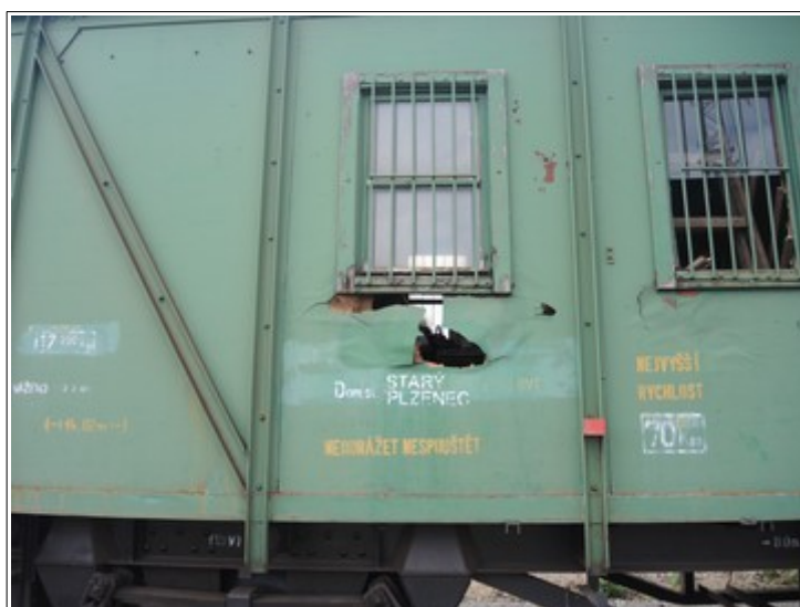
Obr. č. 3: Poškození DV
