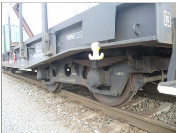
Obr. č. 5: Vykolejená 1. náprava zadního podvozku Zdroj: DI
