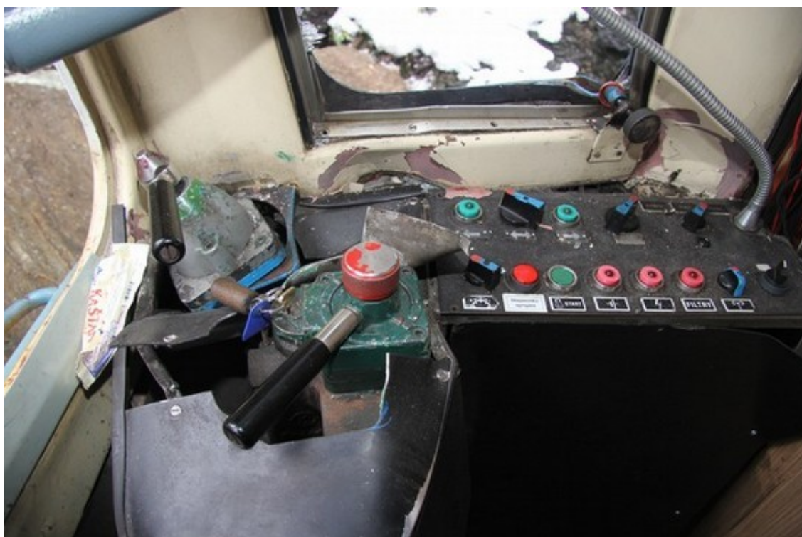
Obr. č. 6: Poloha brzdičů na stanovišti strojvedoucího
