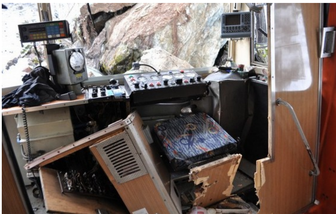
Obr. č. 13: Pohled na zničené stanoviště strojvedoucího
