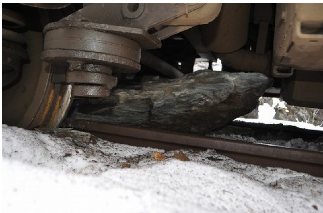
Obr. 7: Pohled na vykolejenou nápravu v důsledku spadlé skály
