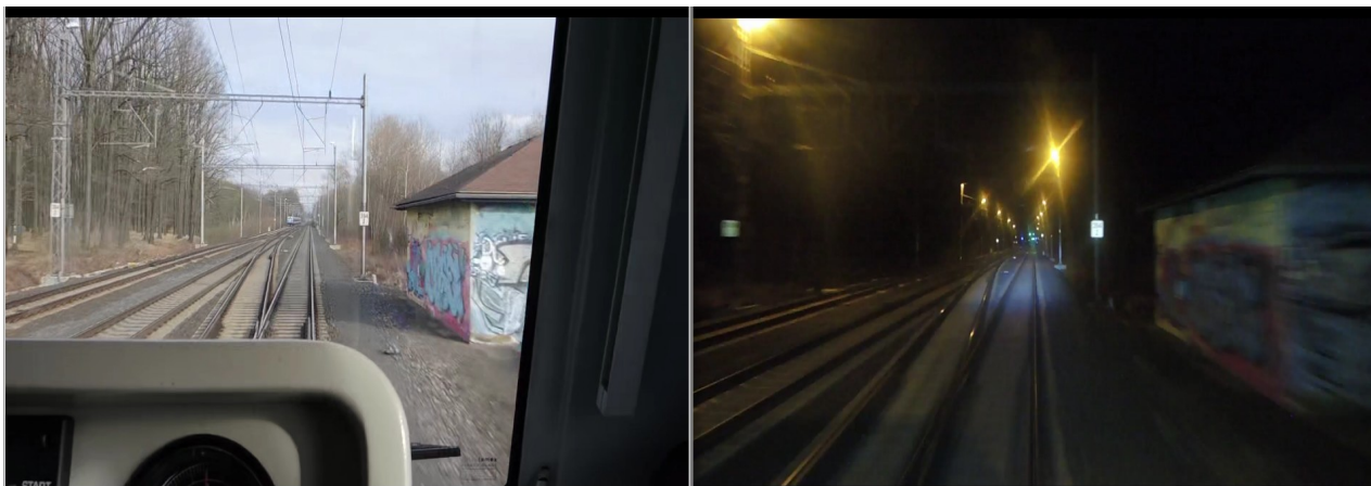
Obr. č. 15: Situace v km 394,200 za denního světla a za tmy, a to při jízdě vlaku po koleji č. 1. Návěstidla v km 393,587 jsou ve tmě již dobře zřetelná. Zdroj: DI
