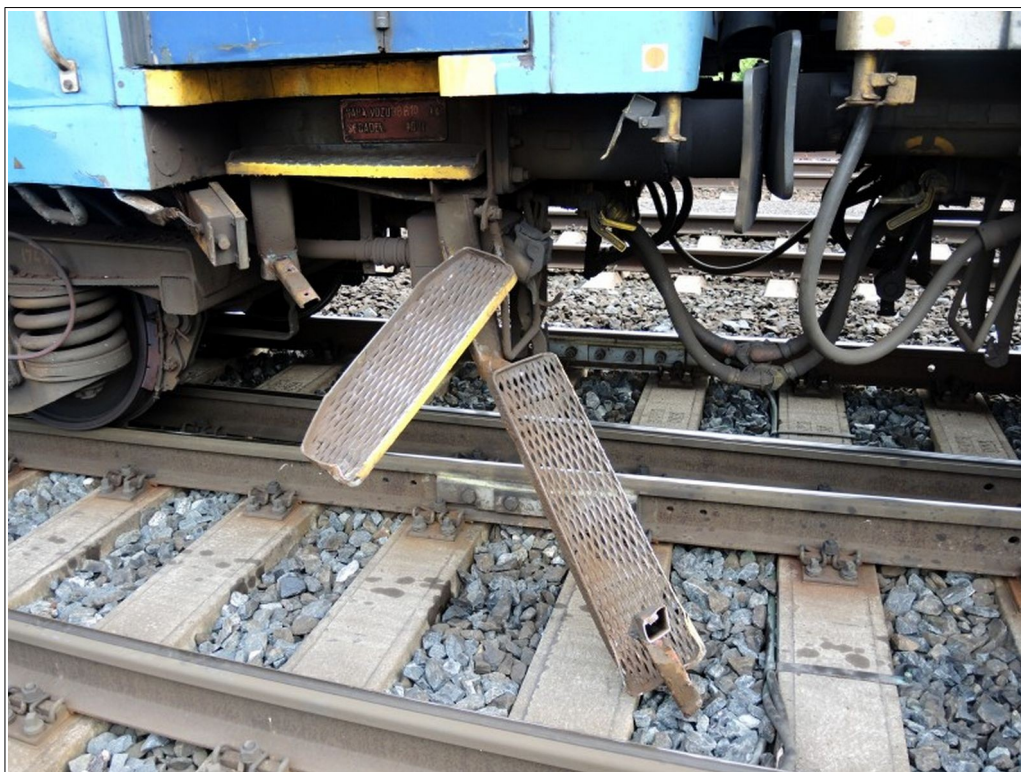
Obr. č. 5: Poškozené nástupní schůdky u jednoho z vozů R 989
