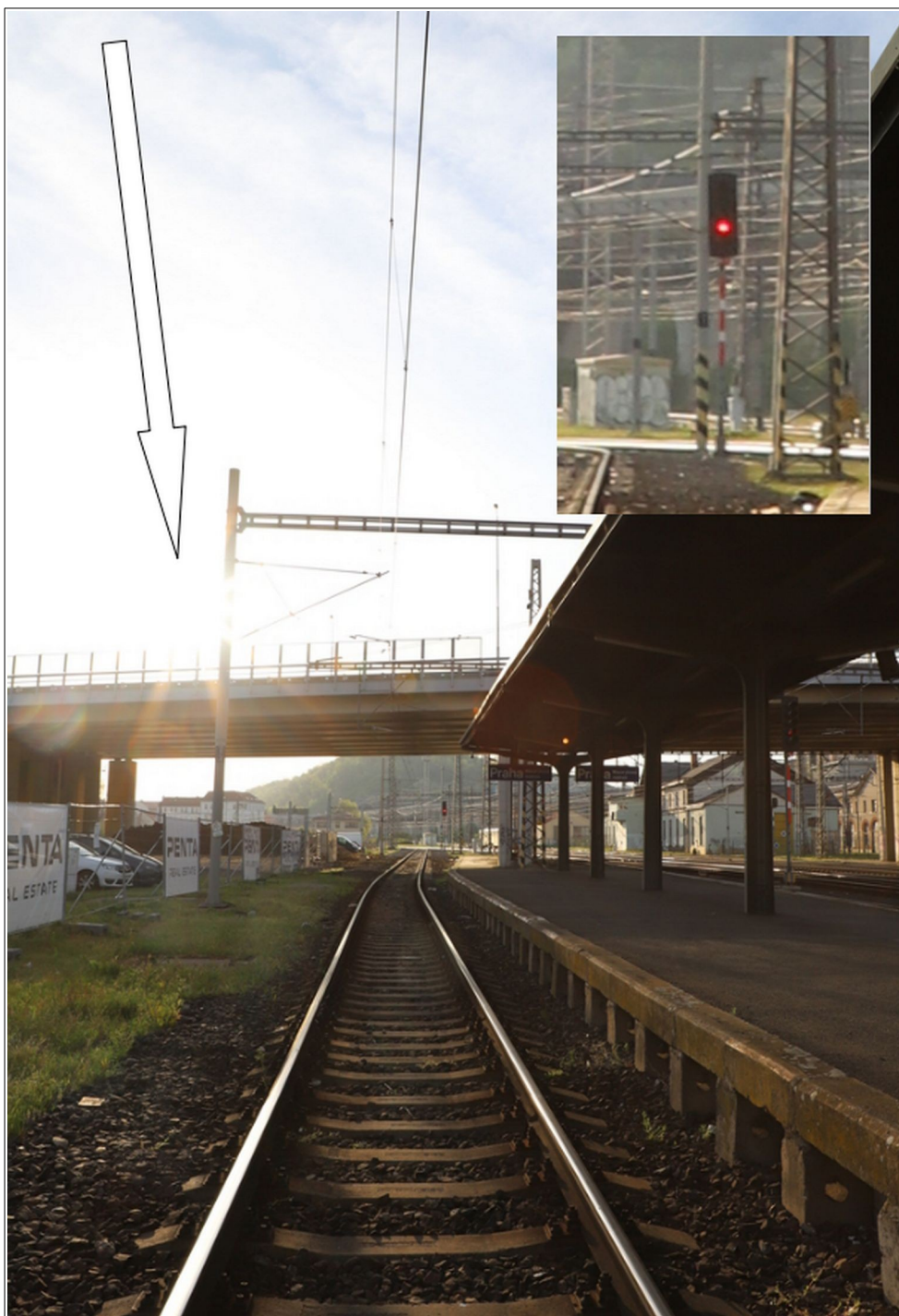
Obr. č. 8: Poloha slunce v čase vzniku MU – snímek, pořízený dne 11. 5. 2021 při stejných světelných podmínkách jako v době vzniku MU, dokládá, že poloha slunce a směr slunečního světla (svitu) neměly na viditelnost cestového návěstidla Sc7 a rozpoznatelnost (nezaměnitelné vnímání) jím návěstěné návěsti „Stůj“ negativní vliv.
