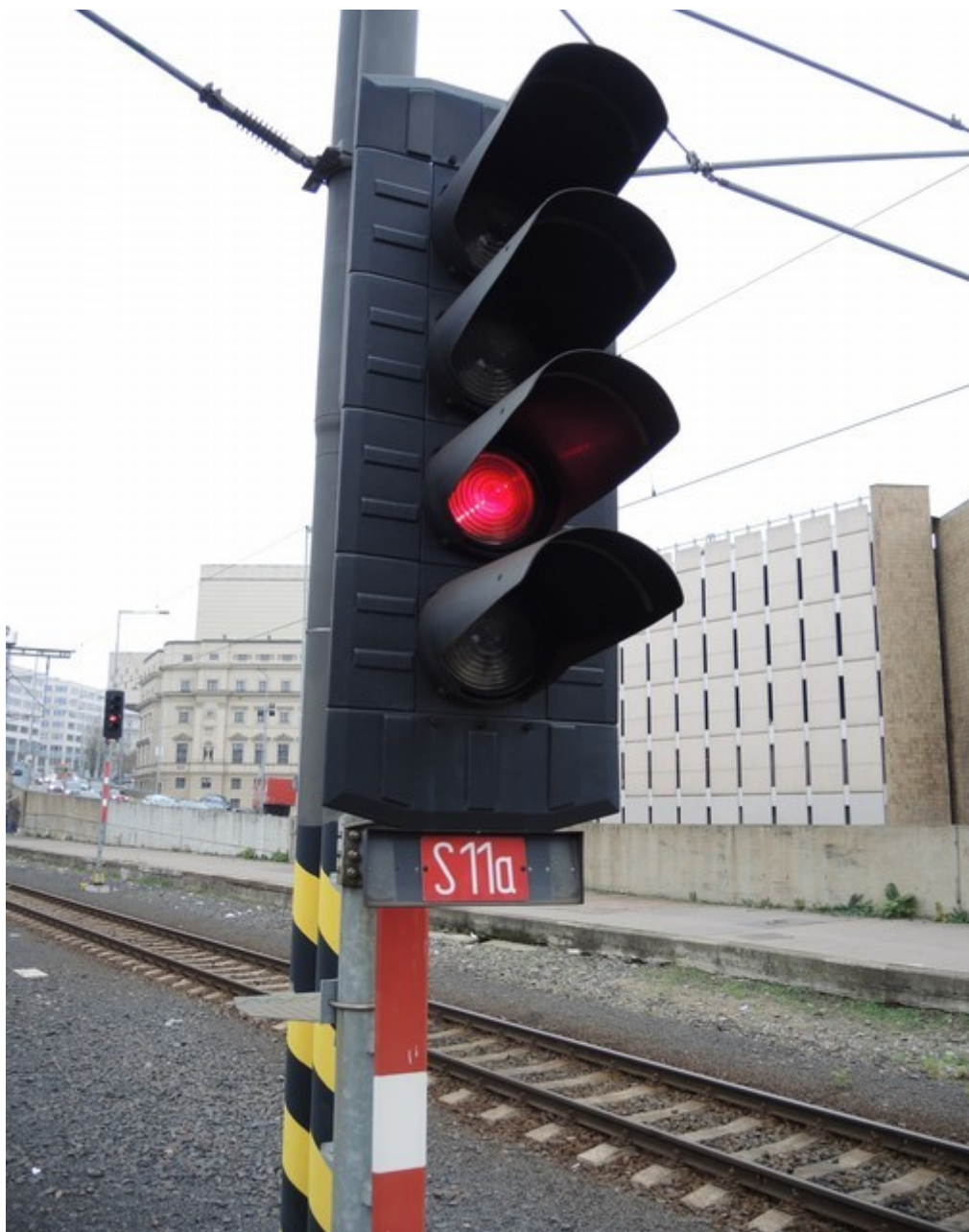
Obr. č. 11: Viditelnost odjezdového návěstidla S11a ze vzdálenosti 2 m, z pozice strojvedoucího mírně vykloněného z bočního okna stanoviště HDV Zdroj: Drážní inspekce
