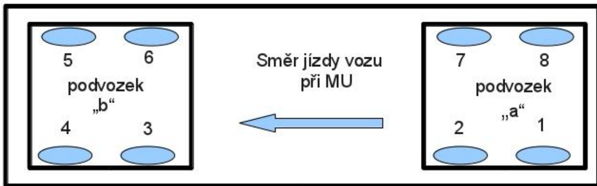
Obr. č. 2: Schema označení podvozků a kol při měření zatížení jednotlivých kol
