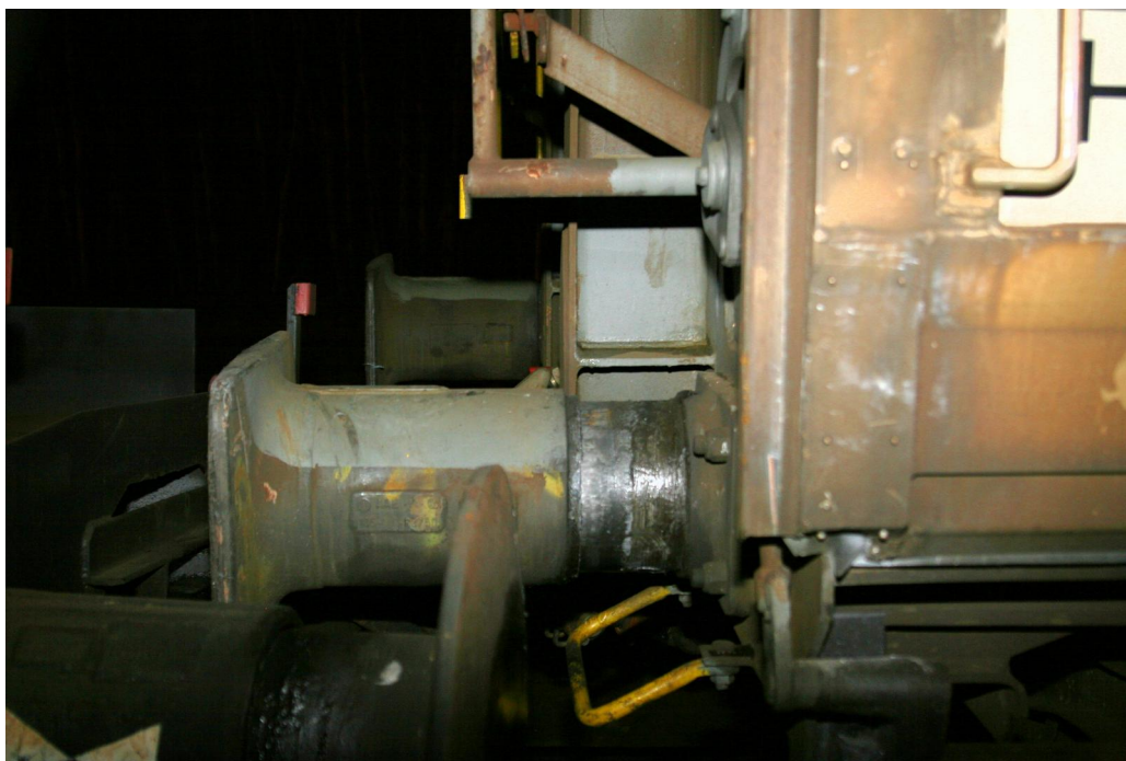
Obr. č. 3: Zaklesnutí nárazníků po MU
